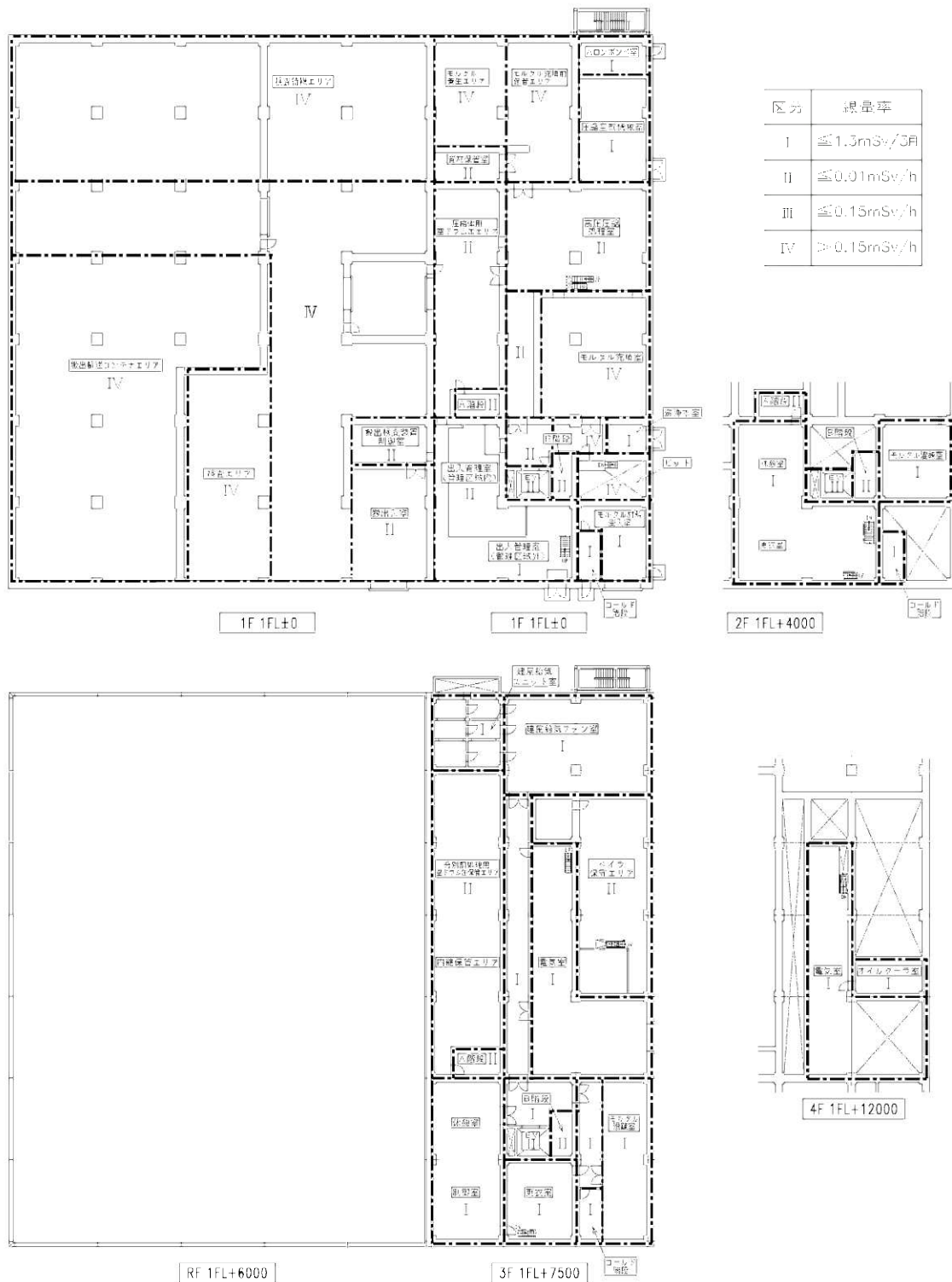
第 30-3 図 廃棄物搬出建屋の線量率区分(1/2)
