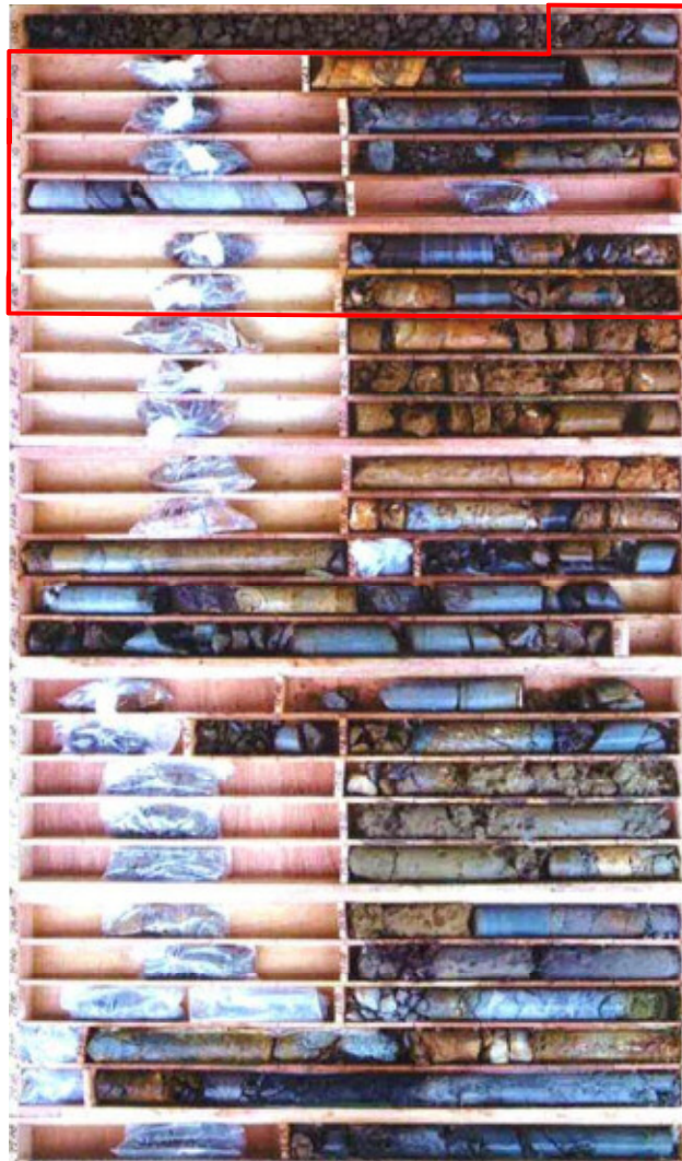
1, 2号炉建設時の埋戻土 ボーリングNo. P11 0.8m~7.0m
