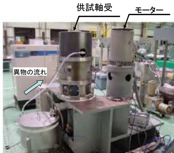
図-2 海水ポンプ軸受摩耗試験装置
