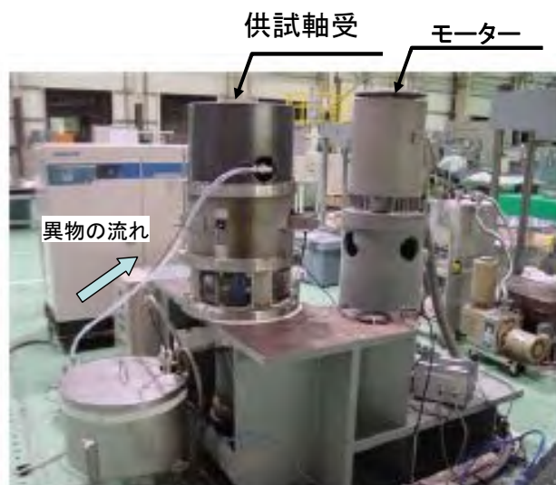
図-2 海水ポンプ軸受摩耗試験装置
