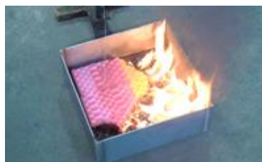
可燃物（スポンジ）にプロアオイルを浸み込ませてガスバーナで炙った後の様子（引火から約8分後）
