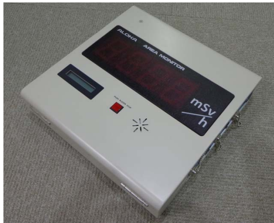
第1図 緊急時対策所エリアモニタ
