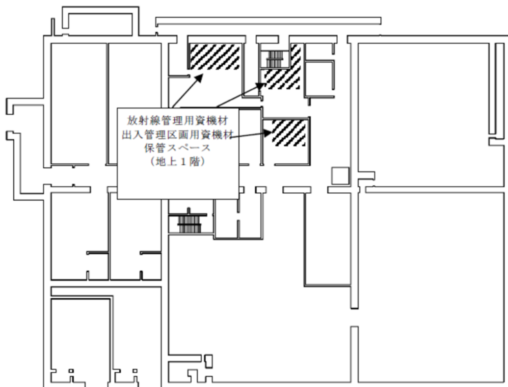
緊急時対策建屋 地上1階 資機材保管場所
