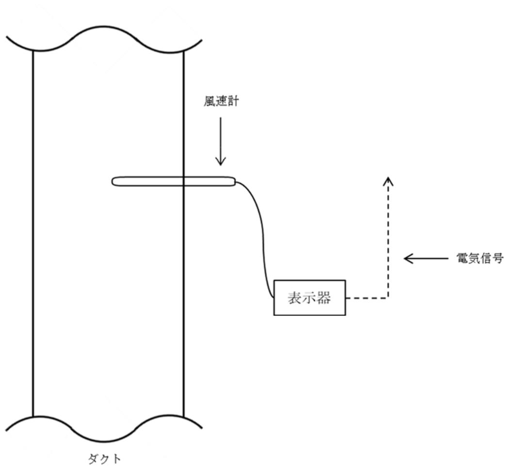
第 2-9.3 図 ダンパ出口風速（熱式風速計）の計測原理図
