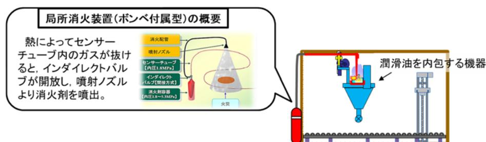
※上図はグローブボックス局所消火装置を示す。遠隔消火装置の場合は、センサーチューブは存在せず、消火ガスボンベを工程室外の廊下に設置する。
