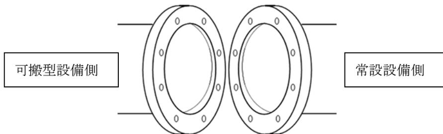
(接続イメージ：可搬型設備と常設設備はフランジにより接続)
