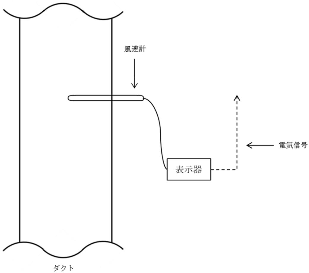
第 29. 7 図 可搬型ダンパ出口風速計の計測概要図
