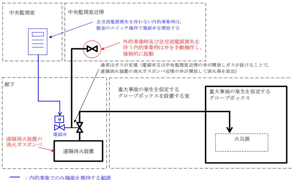
第2-4.4図 遠隔消火装置の概略構成
