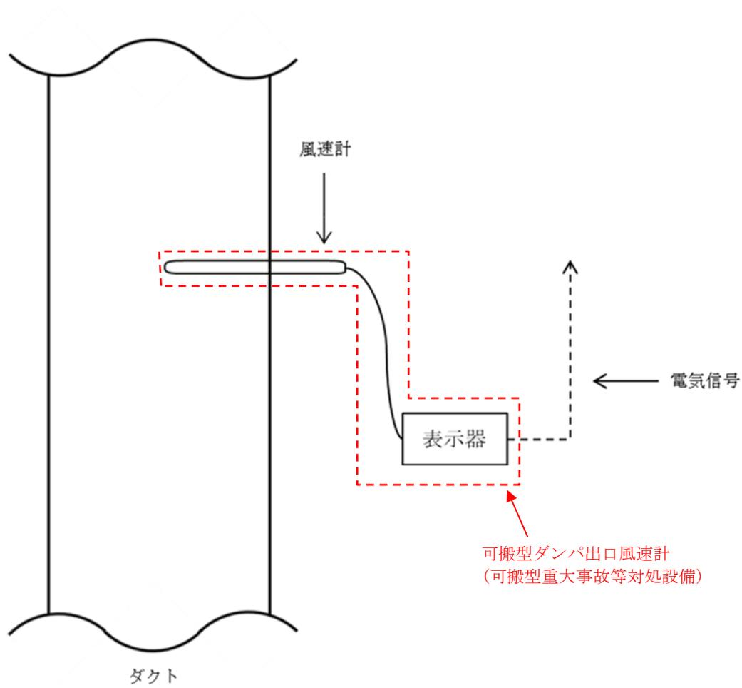
第 2-6.3 図 可搬型ダンパ出口風速計の接続図
