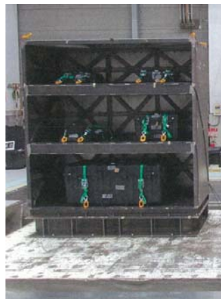
収納箱を保管棚に固縛した状態
