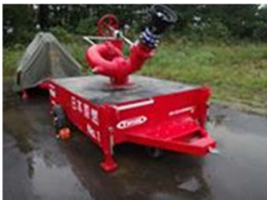
可搬型放水砲
