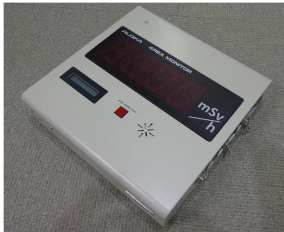
第5図 緊急時対策所エリアモニタ
