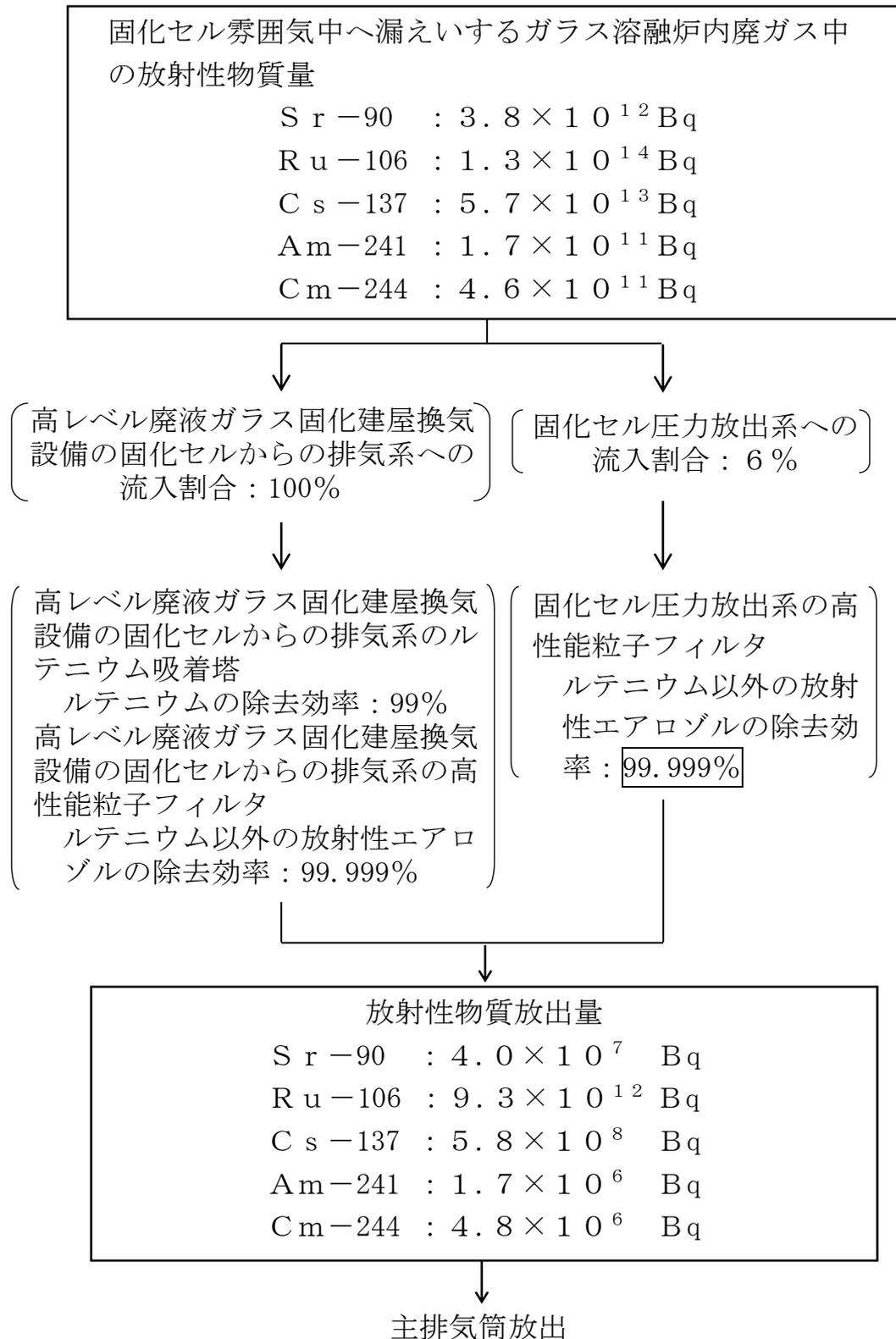
第1図 短時間の全交流動力電源の喪失時の放射性物質の大気放出過程
