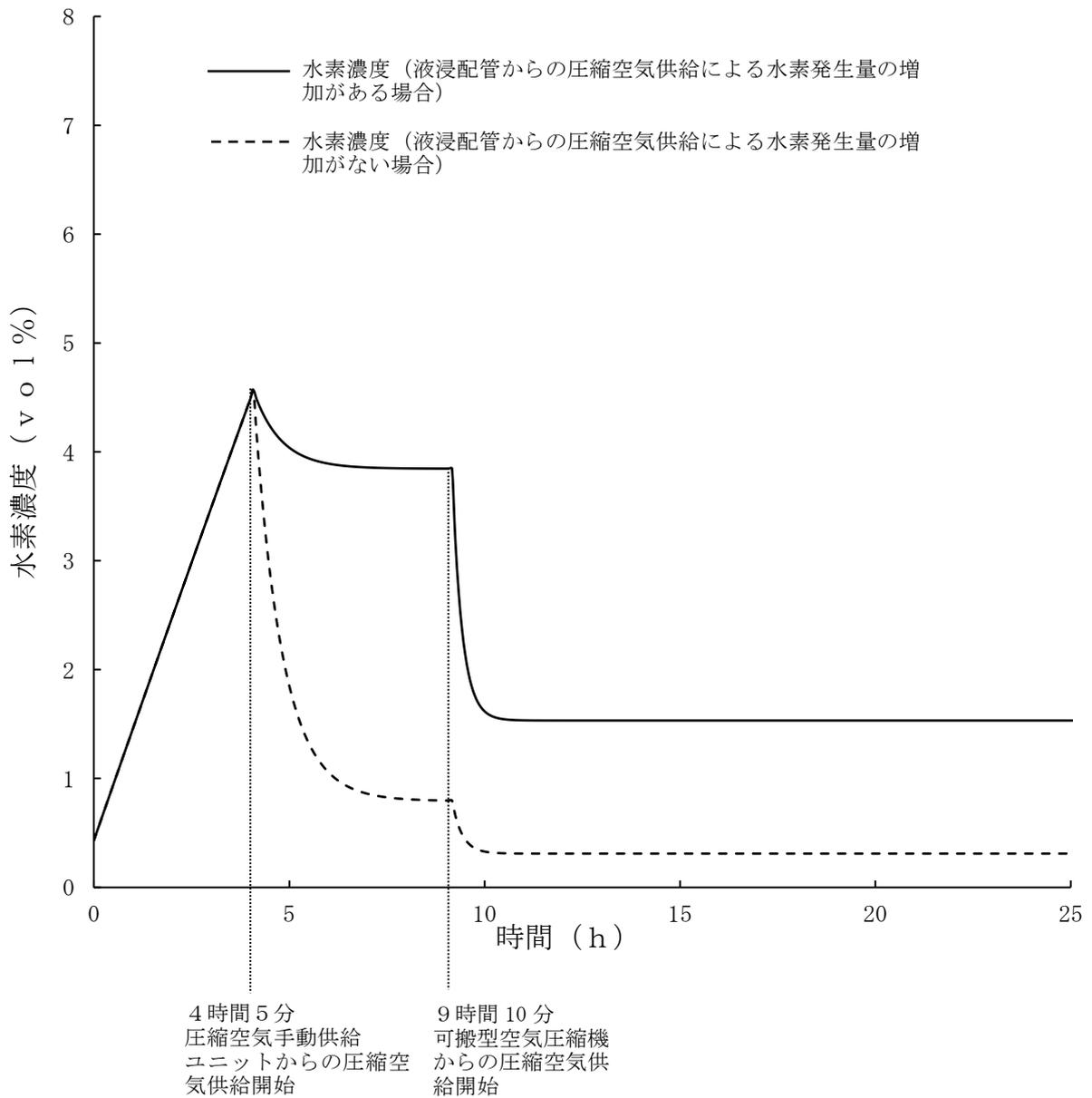
第7.3-17図 水素爆発の再発を防止するための空気の供給実施時の第2一時貯留処理槽の水素濃度の傾向 (分離建屋)
