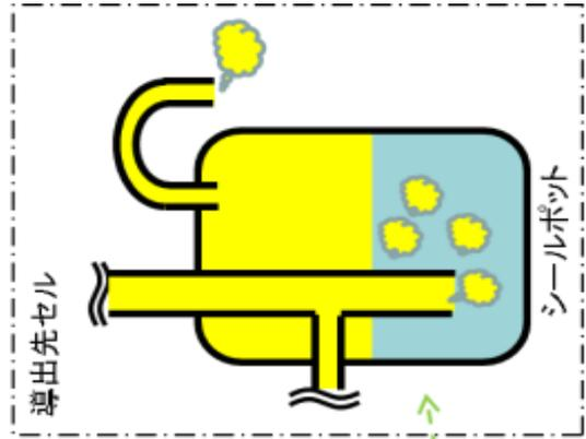
第2.1-2図 安全水封器の概要図
