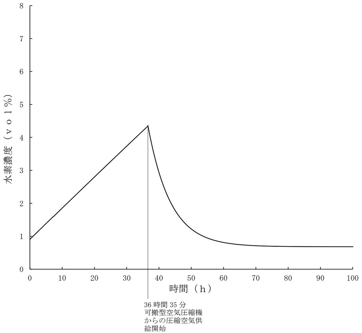
第7.3-10図 水素爆発を未然に防止するための空気の供給実施時の計量前中間貯槽の水素濃度の傾向（前処理建屋）
