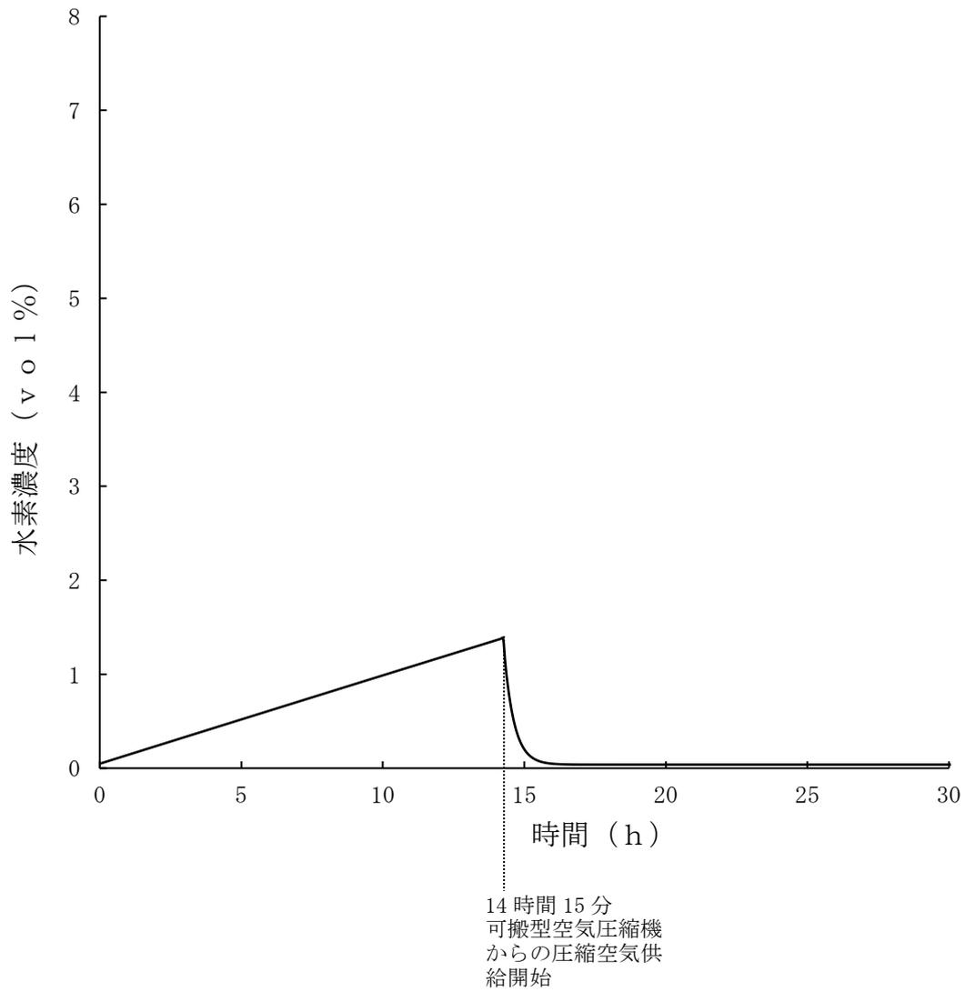
第7.3-14図 水素爆発を未然に防止するための空気の供給実施時の高レベル濃縮廃液貯槽の水素濃度の傾向（高レベル廃液ガラス固化建屋）
