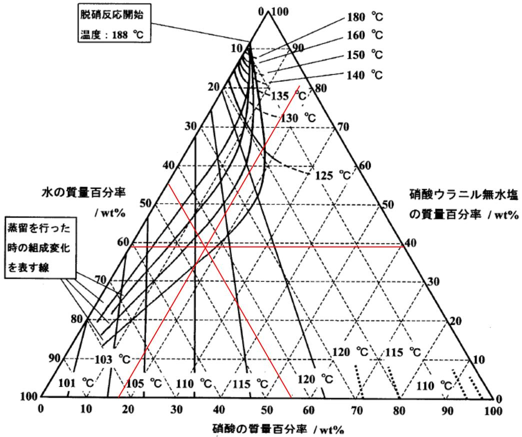
図1. 5-2 硝酸ウラニル-硝酸-水3成分系の沸点。<sup>4)</sup>
