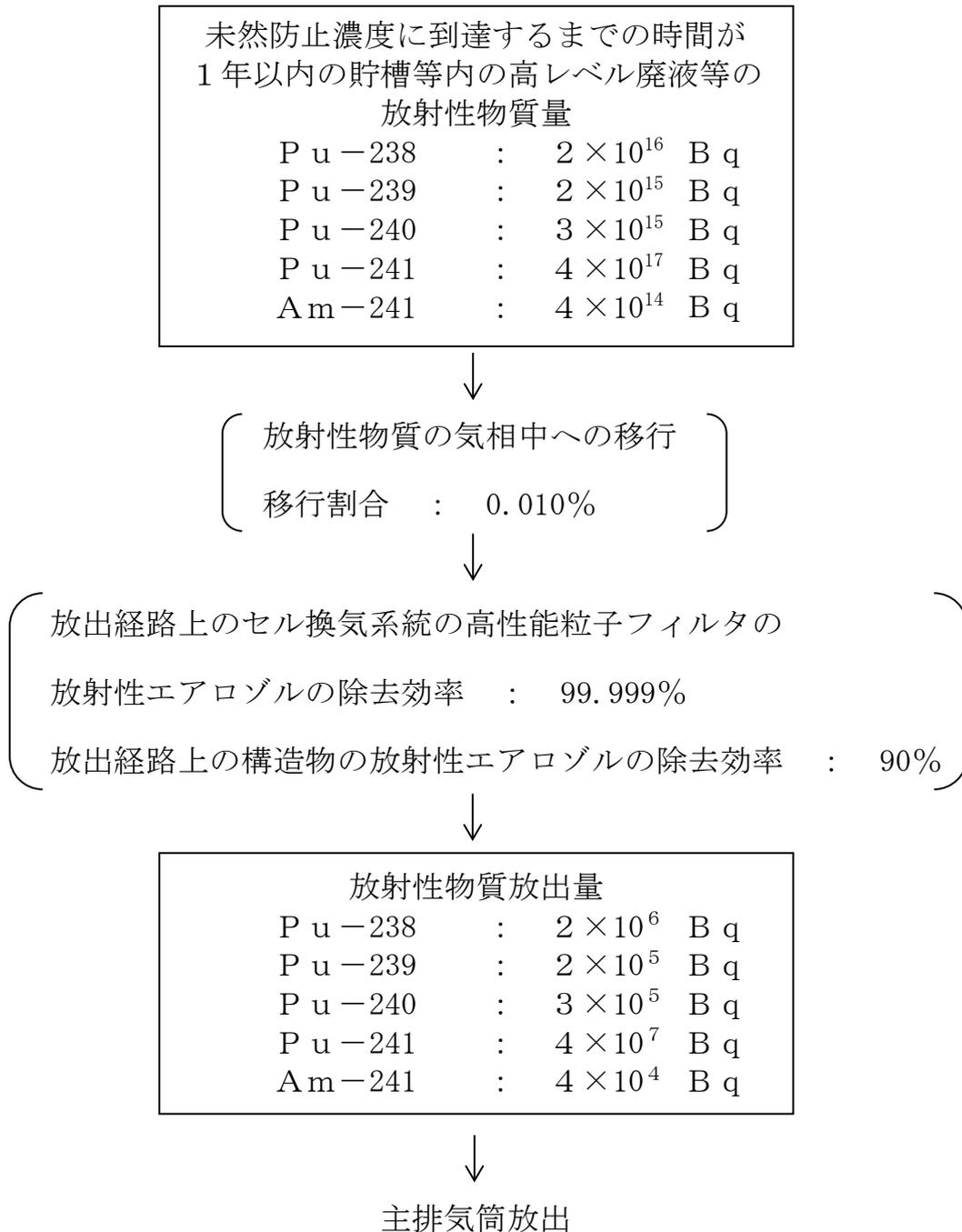
第7.3-29図 放射性物質の大気放出過程（ウラン・プルトニウム混合脱硝建屋）
