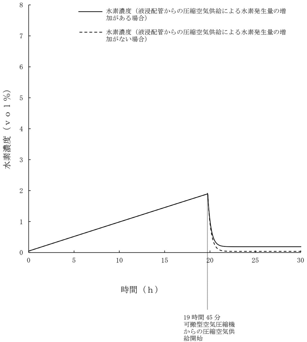
第7.3-20図 水素爆発の再発を防止するための空気の供給実施時の高レベル濃縮廃液貯槽の水素濃度の傾向 (高レベル廃液ガラス固化建屋)
