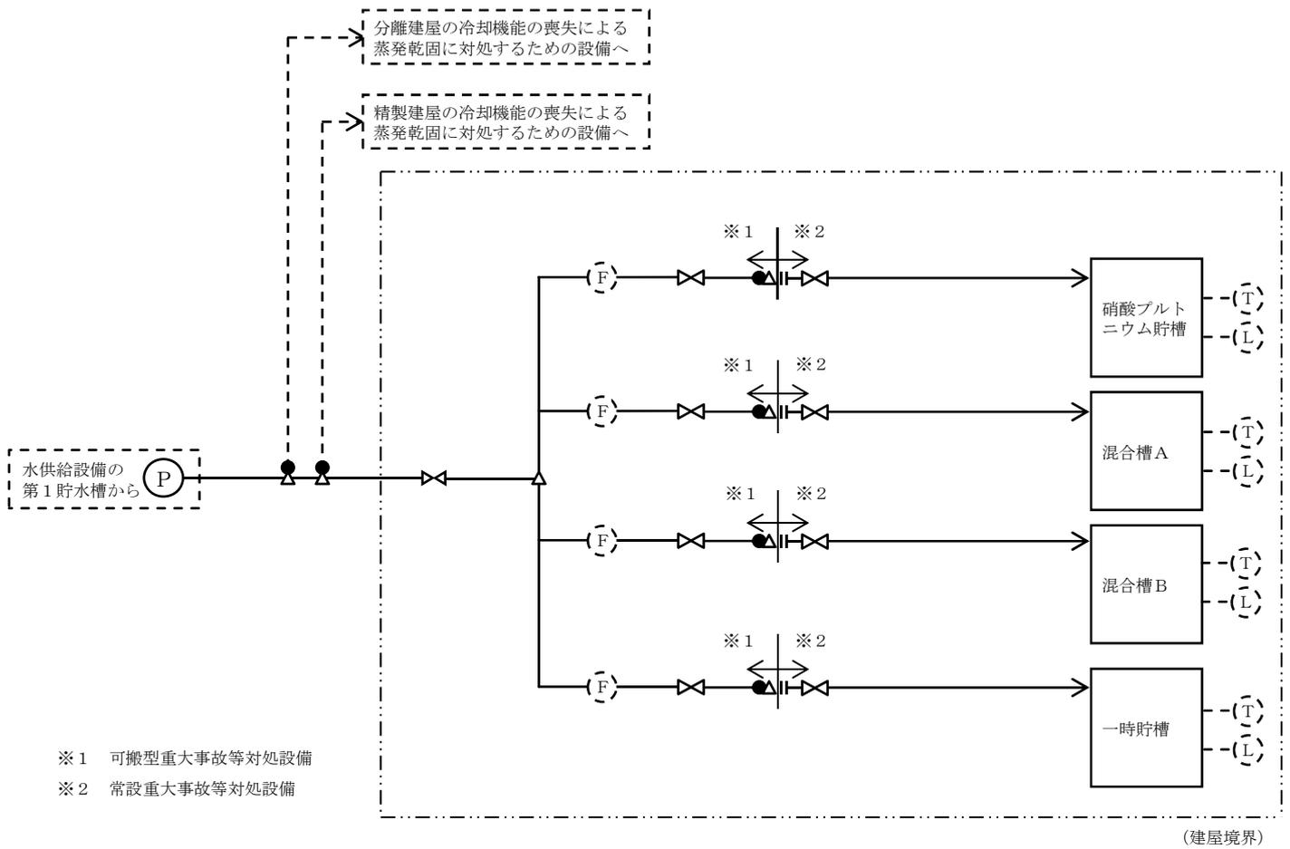
本図は、第1接続口に接続した場合の例である。接続口毎に機器注水配管が異なるため、第2接続口から第4接続口に接続する場合は系統構成が異なる。また、接続金具等の個数及び位置についても、ホース敷設ルートごとに異なる。
