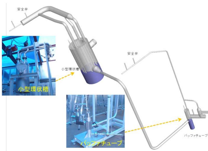
第2図 T B P 洗浄塔を模擬した容器
