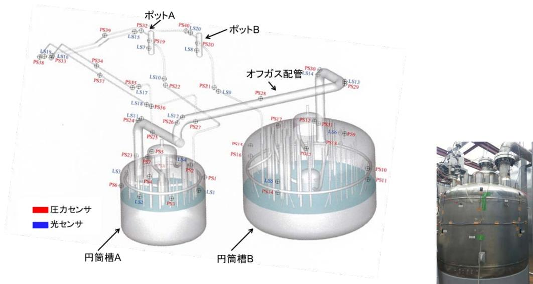
第 6 図 不溶解残渣回収槽、リサイクル槽のモデル
