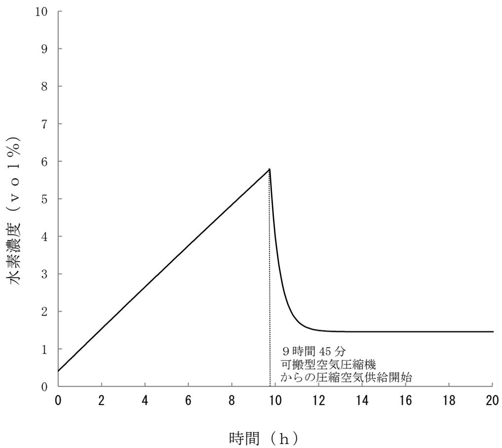
第7.3-18図 水素爆発の再発を防止するための空気の供給実施時のプルトニウム溶液供給槽の水素濃度の傾向 (精製建屋)
