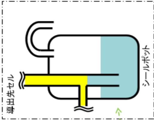
蒸発乾固発生時 加圧状態
