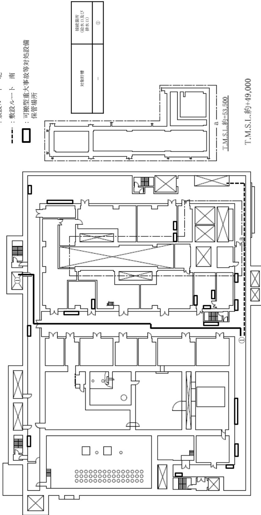
蒸発乾固の発生防止対策（内部ループへの通水による冷却）の建屋内ホース敷設ルート
