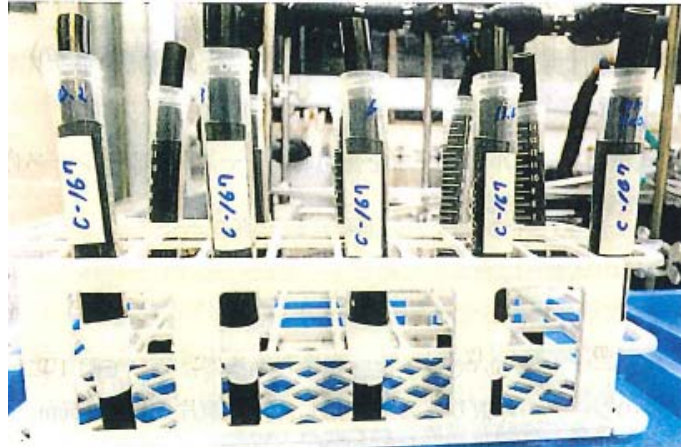
図2 ケーブルシースの耐薬品性試験の状況
