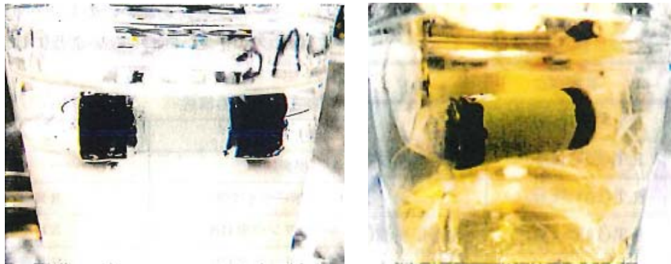
図2 塗裝配管の浸漬・曝露試験状況
