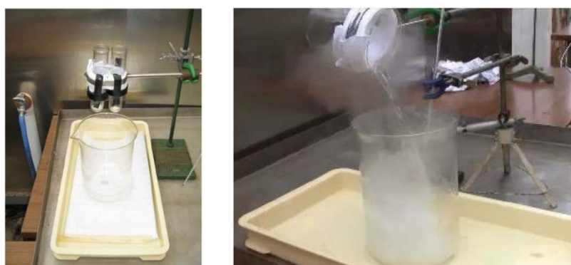
第 2.3-2 図 中量混合試験装置
