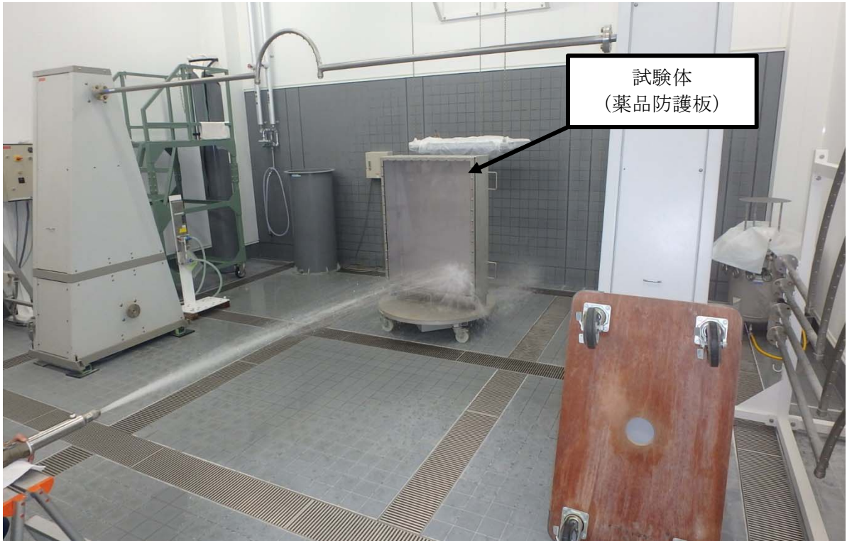
第4図 耐水試験の例（薬品防護板）
