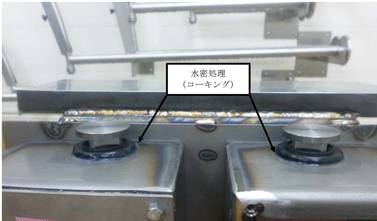
第2図 水密処理の例（イメージ）
