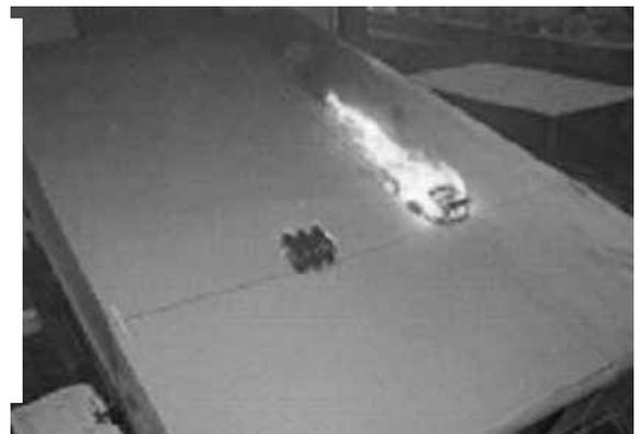
試験の合否判定基準は「火炎の先端部が、試験体の端部まで達しないこと。試験体裏面で火炎を伴う燃焼が観測されないこと。1×1cmを超える貫通孔が観察されないこと」となっています。
