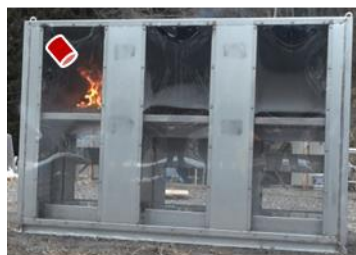
火災源直上から約400mmに設置
