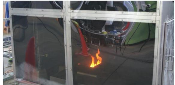
図1. グローブボックス模擬態体内における潤滑油の燃焼状況
