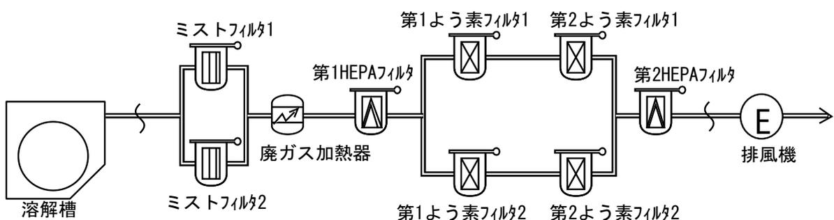
第1図 せん断処理・溶解廃ガス処理設備系統概要図
