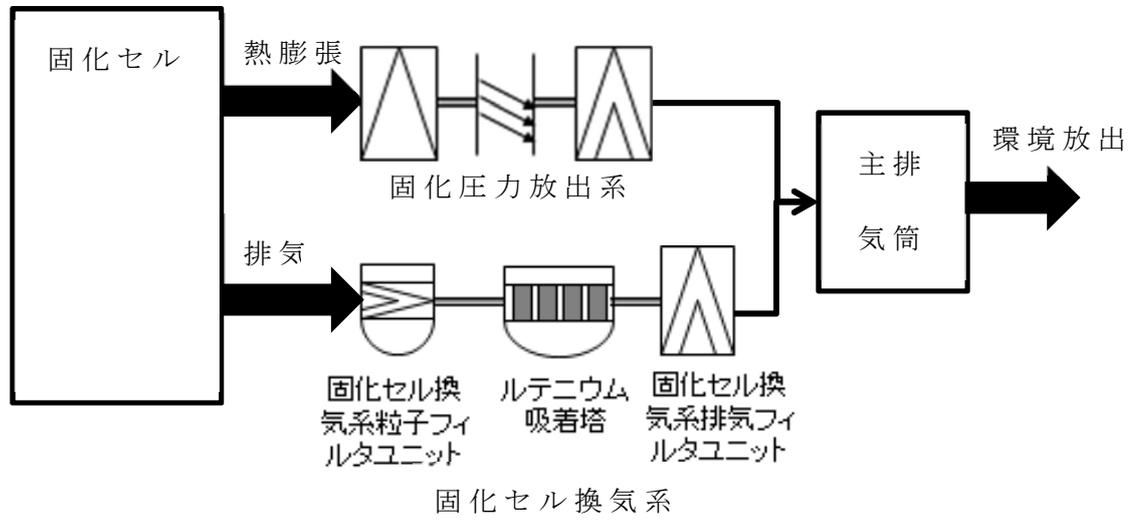
第4図 固化セル換気系統概略図
