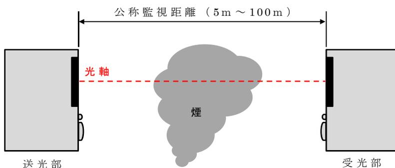
第 1 図 光電式分離型感知器の概要
