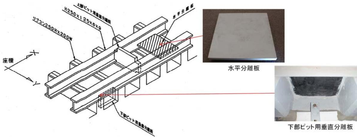
コンクリート壁 (200mm) , H鋼 (最低厚 6mm) , 及び分離板 (不燃性 30mm)
