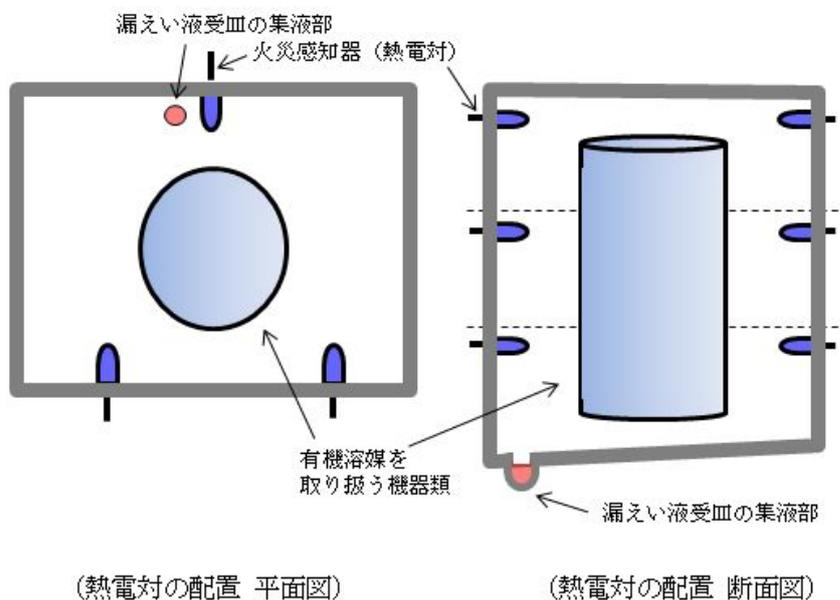
セル内は高放射線環境のため、消防法適用品は対応しないことから、熱電対により火災を感知する。しかし、熱電対は、火災による熱を感知するため、熱感知器の設置基準に従い設置している。
