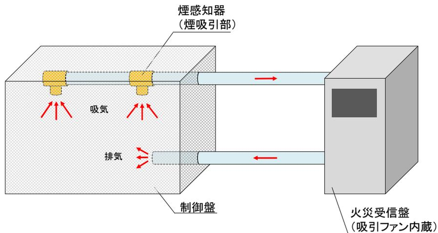
第 1 図 高感度煙感知器（吸引式）の設備概要（例）
