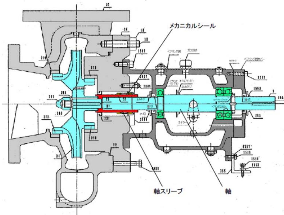
第1図 渦巻ポンプシール構造による漏えいの防止対策概要図
