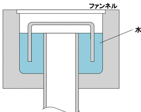
第3図 ファンネルへの水封例
