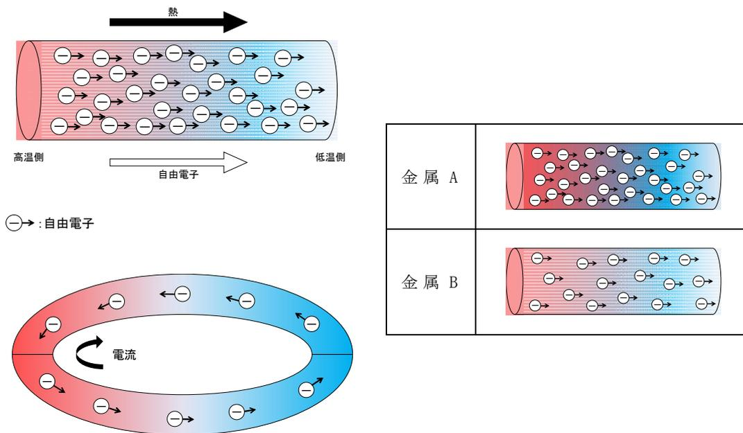
第 1 図 温度測定 の 原理
