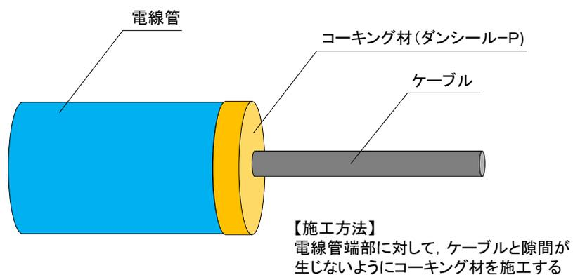
第2図 非難燃ケーブルの電線管内への敷設イメージ
