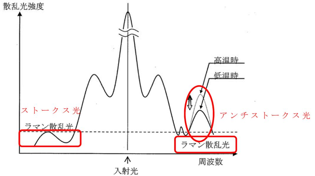
第 1 図 温度測定 の原理
