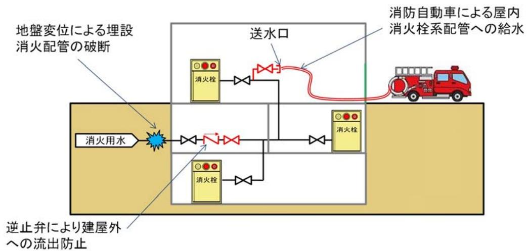
第7図. 地盤変位対策の概要
