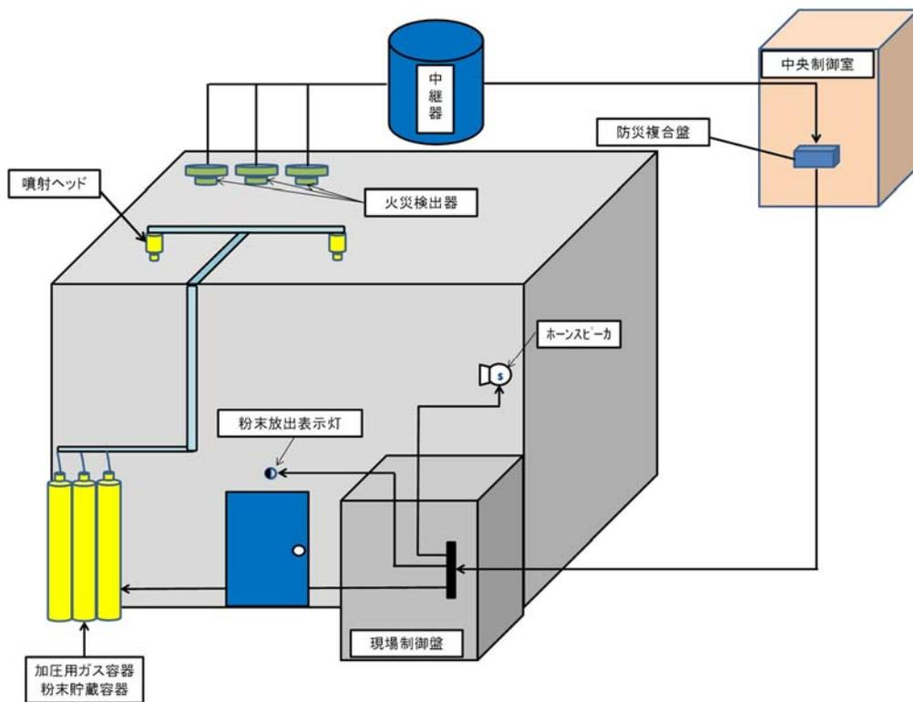
第4図 粉末消火設備の概要図
