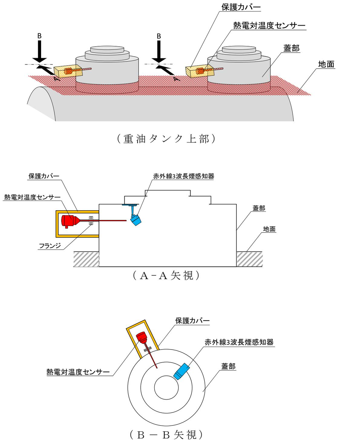
第2図 重油タンク室に対する熱電対の設置例
