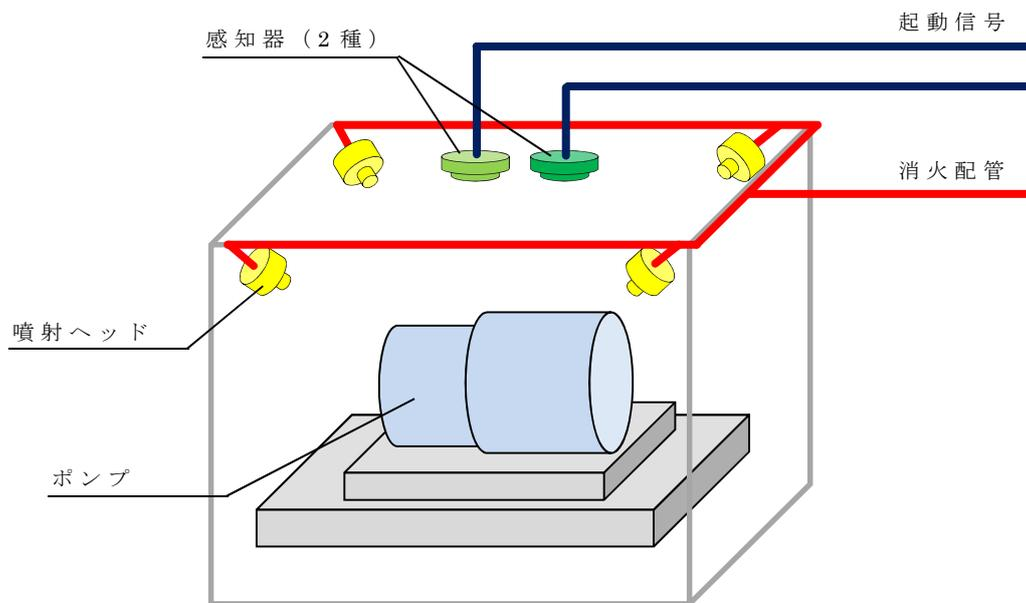
第6図 ポンプ等に用いる局所消火設備の設置概要
