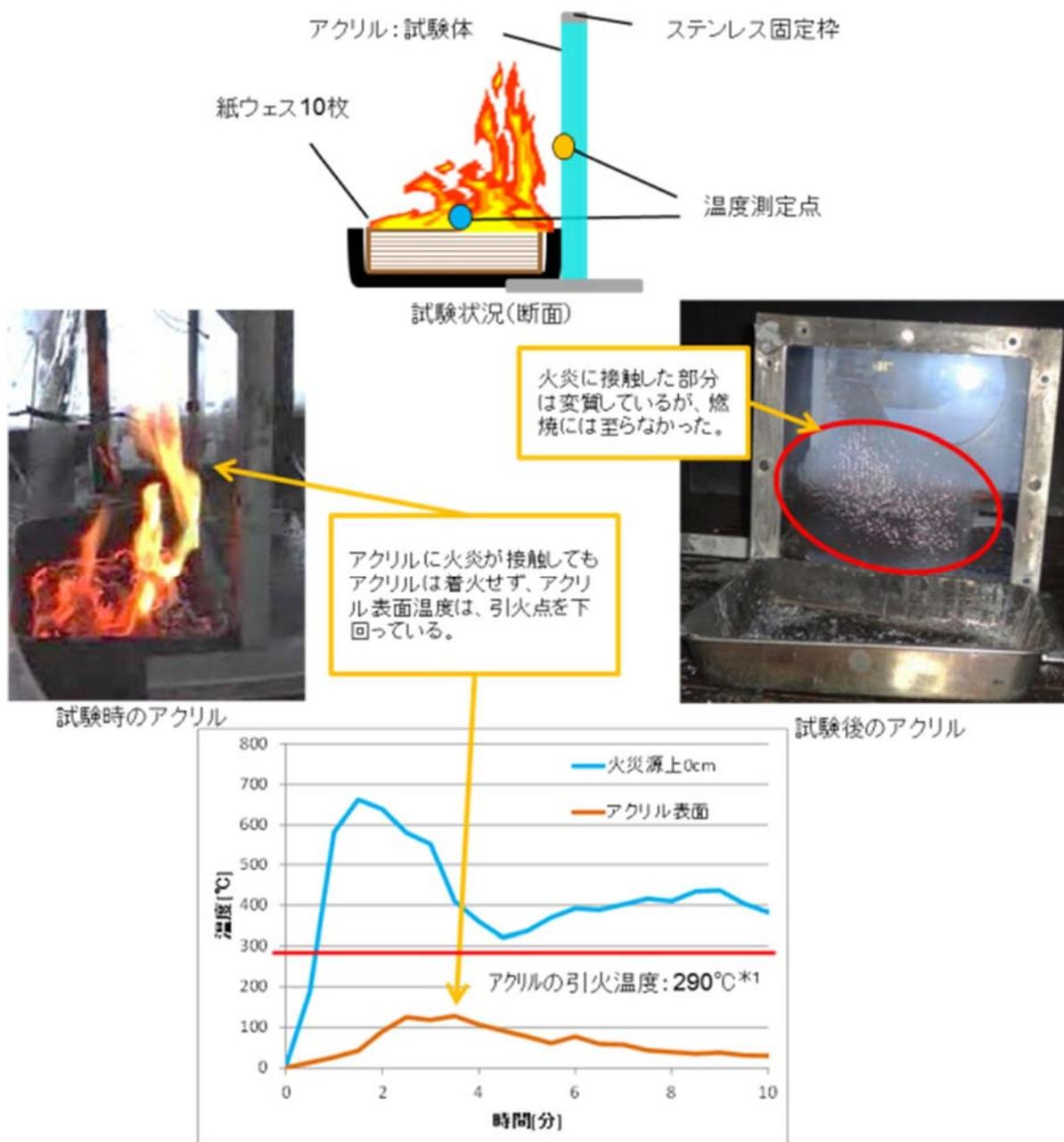
第1図 アクリルパネルの燃焼試験
