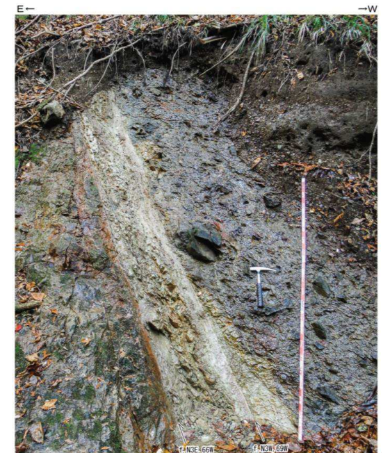
Loc. H-3 東通村老部川支流 東側の泊層火山凝灰岩と西側の蒲野沢層礫岩・泥岩とを境する断層。2条の断層面に挟まれる幅約45cmの間は細片状～粘土状の破碎部となっている。
