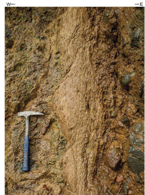
同左拡大 破砕部は幅35~45cmで、シルト質鱗片状破砕部及び細片状セピオライトからなり、軟質である。
