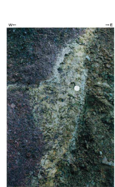
同左拡大 断層面沿いには幅1~10cmの黄褐色砂質粘土がみられ、同粘土は一部で西側の溶岩中に侵入している。
