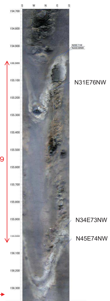
F-9断層破砕部は非固結 (細片状, 粘土状(パリゴルスカイト化))
