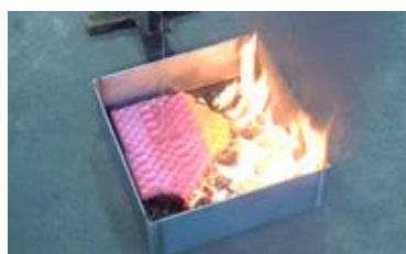
可燃物（スポンジ）にプロアオイルを浸み込ませてガスバーナで炙った後の様子（引火から約8分後）
