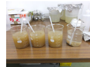
ビーカーを用いた水簸の例
