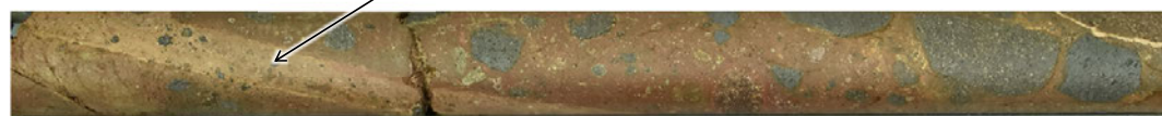
破碎部中に粘土鉱物が認められる事例 (試料e. 岩盤調査坑 No.27孔 深度0.25m付近)
