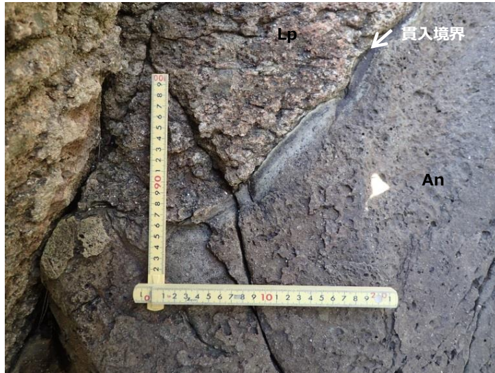
図2-8 (13) 防波壁(東端部)露頭状況 P13 安山岩岩脈上盤境界 貫入境界は火山礫凝灰岩に密着し、安山岩側に急冷縁あり。
