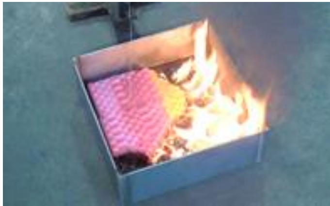
図2 可燃物（スポンジ）にブローオイルを浸み込ませてガスバーナで炙った後の様子（引火から約8分後）
