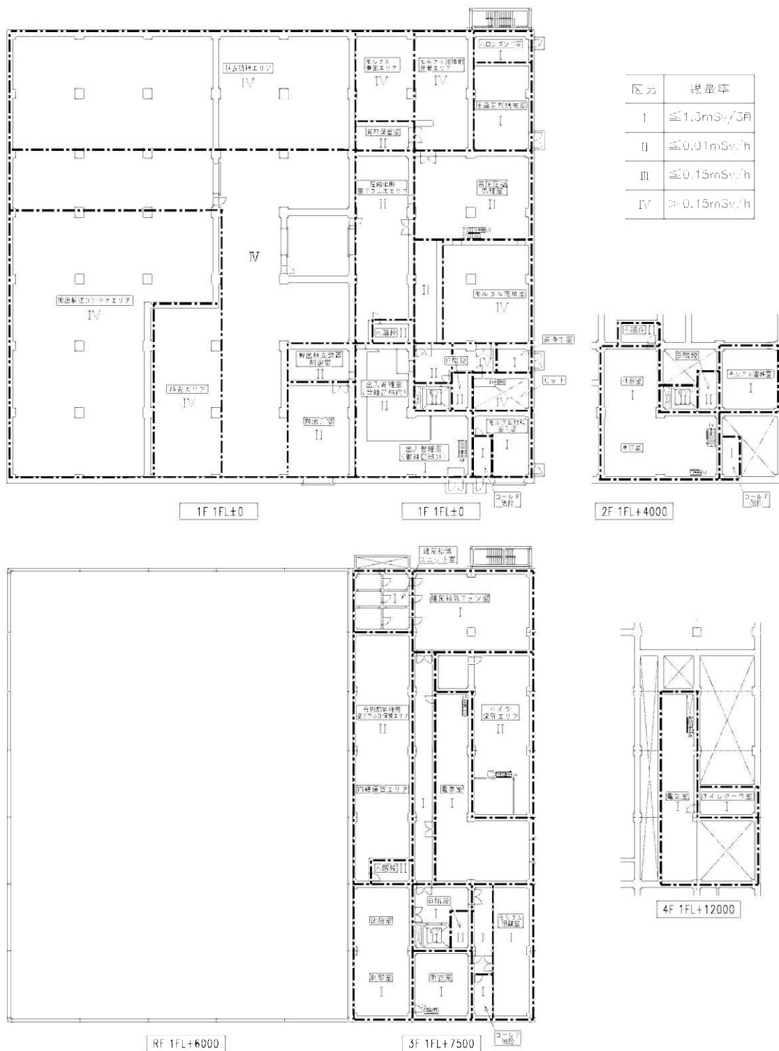
第 30-3 図 廃棄物搬出建屋の線量率区分(1/2)
