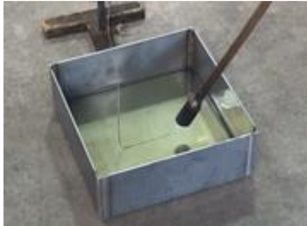
図1 ブロアオイルを約1分ガスバーナで炙った様子（引火せず）
