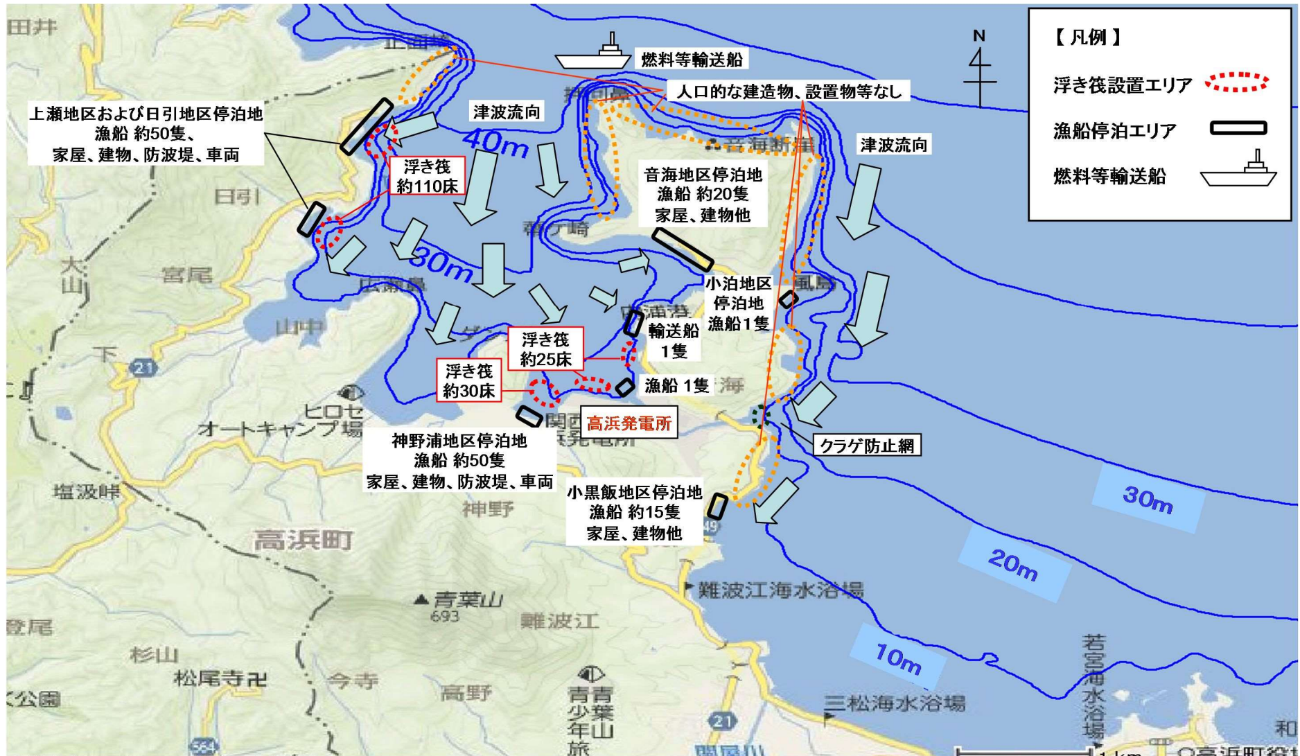
図 17 発電所構外における漂流物となる可能性のある施設・設備等の抽出結果
