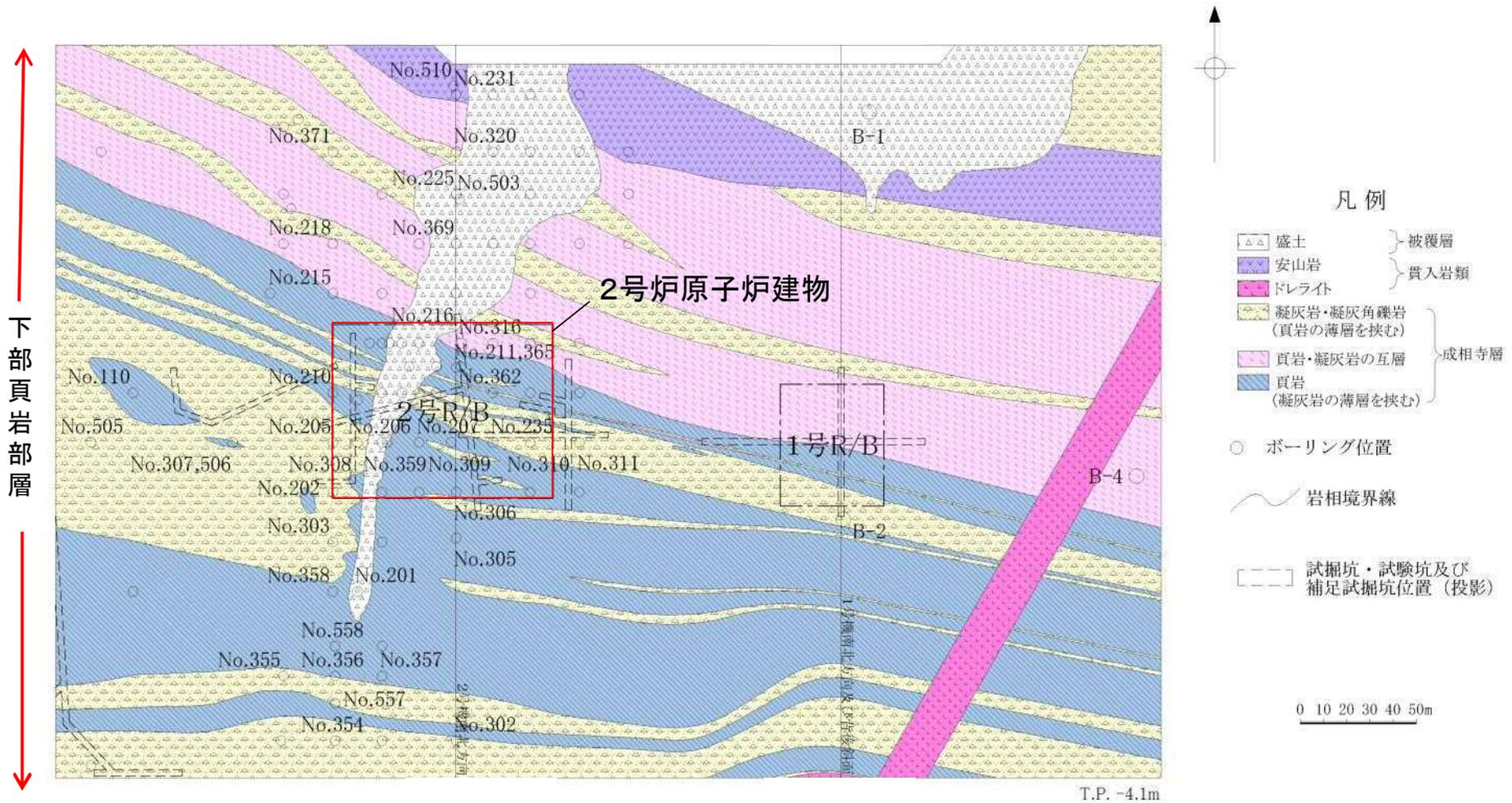
・成相寺層の構造は、概ね西北西－東南東の走向を示す。
