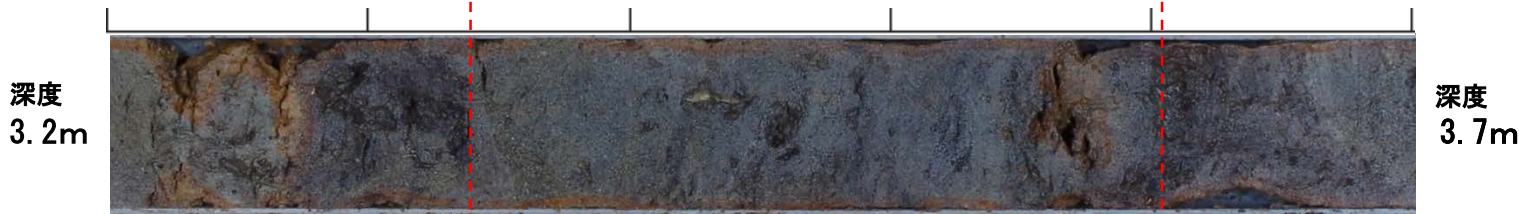
ボーリングコア写真
