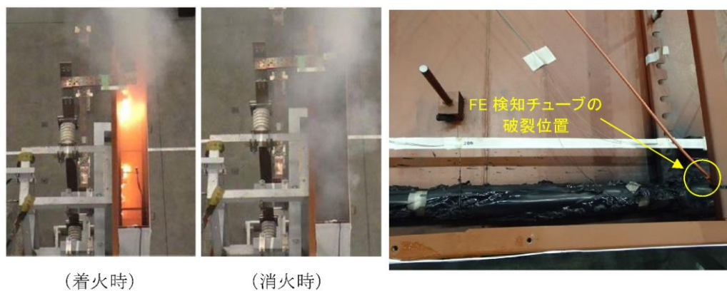
第9図 試験V1における発火・消火時の状態
