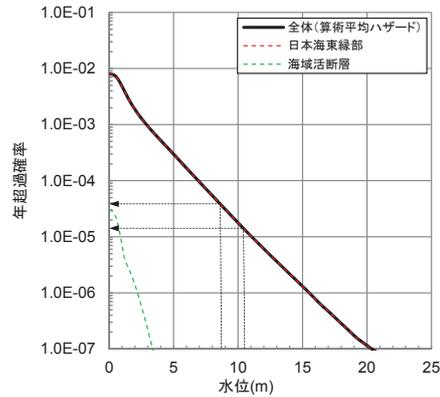
補足説明資料 6. 施設護岸又は防波壁, 2号炉取水口及び2号炉取水槽における津波ハザード評価結果
