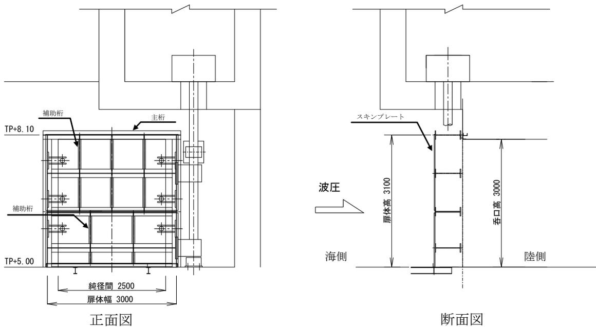
図8 1号放水連絡通路防波扉構造図
