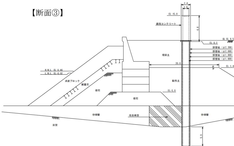
図2 防波壁評価対象断面図 (単位：m)
