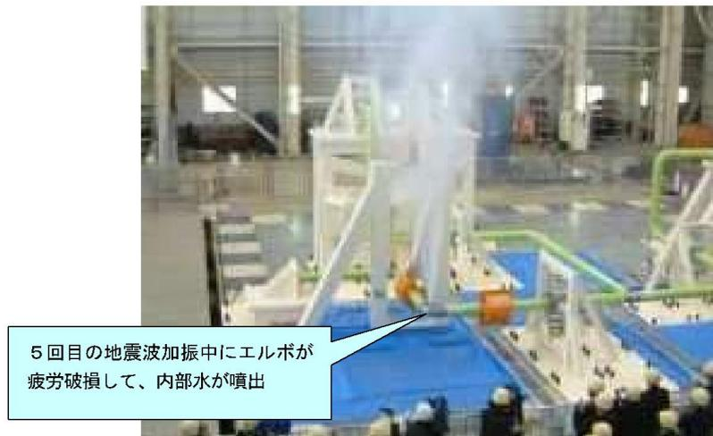
図1 平成15年配管系終局強度試験（出典：JNES HP）
