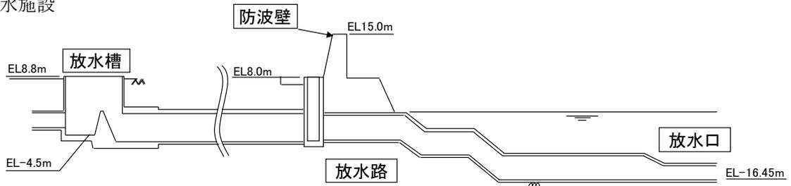
図4 島根2号炉 取水・放水施設
