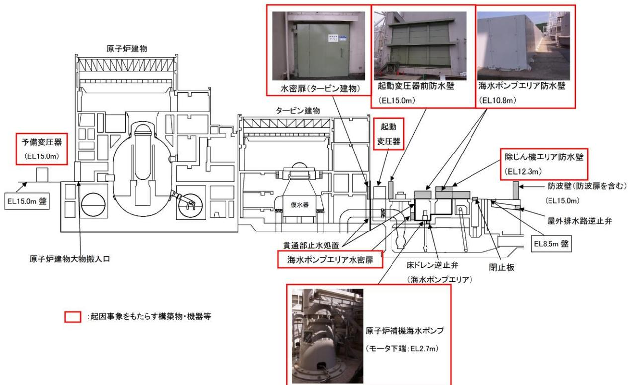
図1 起因事象をもたらす構築物・機器等とプラント概要図
