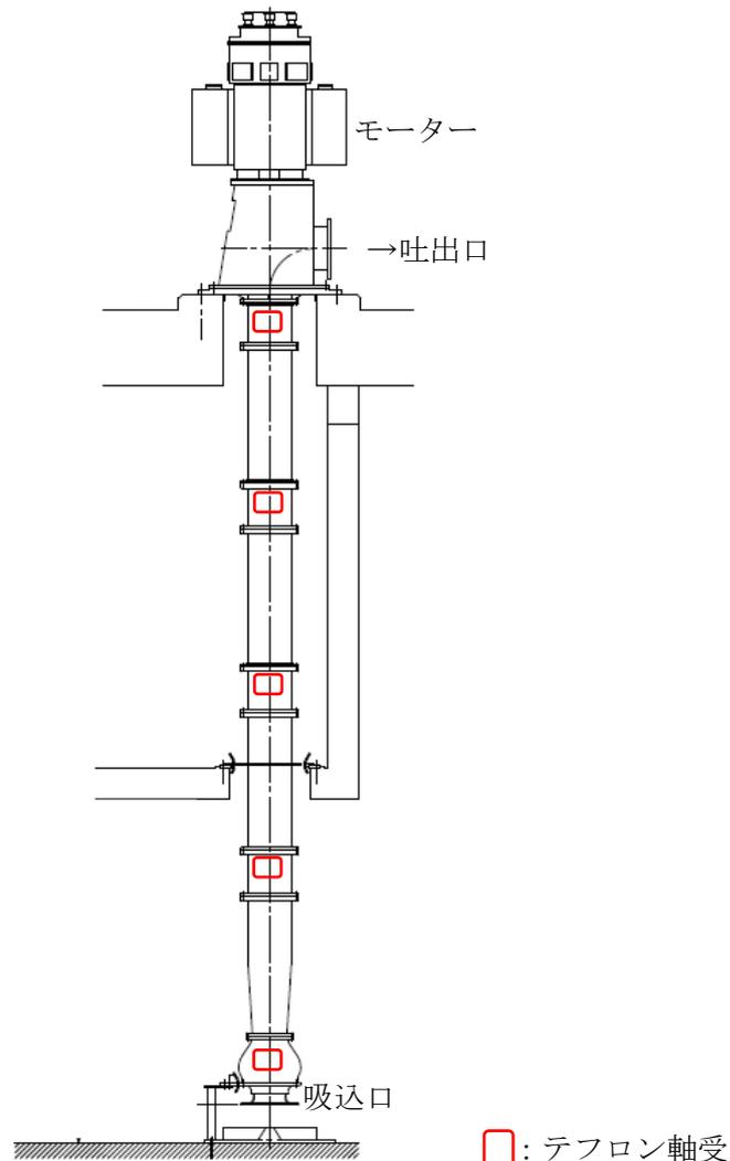
添図1 島根2号機R S Wポンプの断面図
