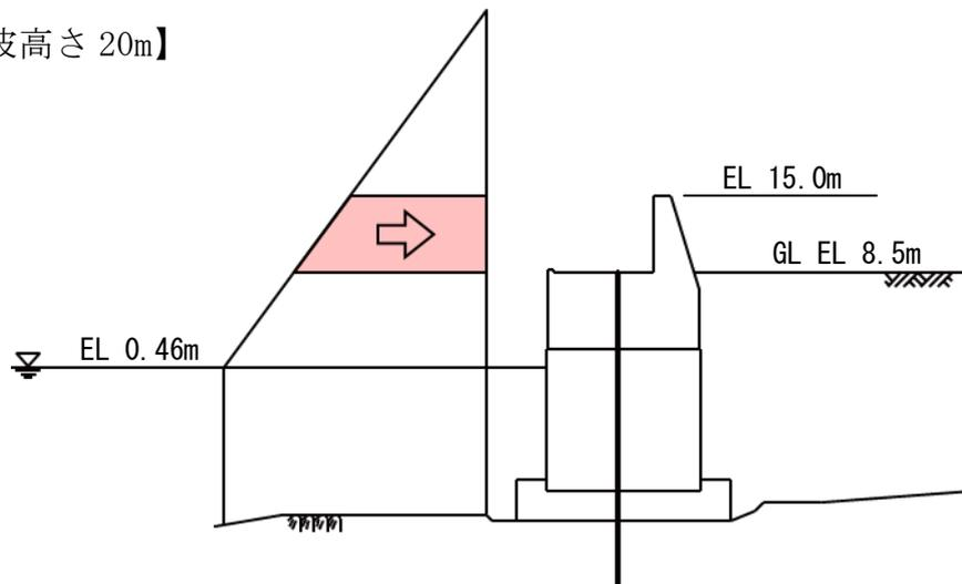
図 3 津波波力分布図（断面①）
