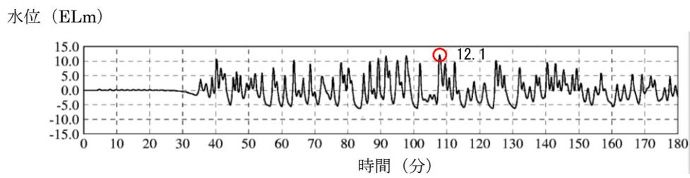
図6 除じん機エリアでの時刻歴波形
