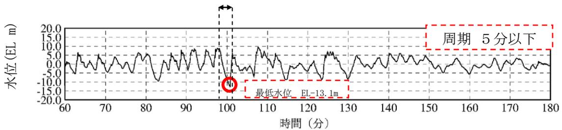
図 1 EL20m 津波での取水口での時刻歴波形
