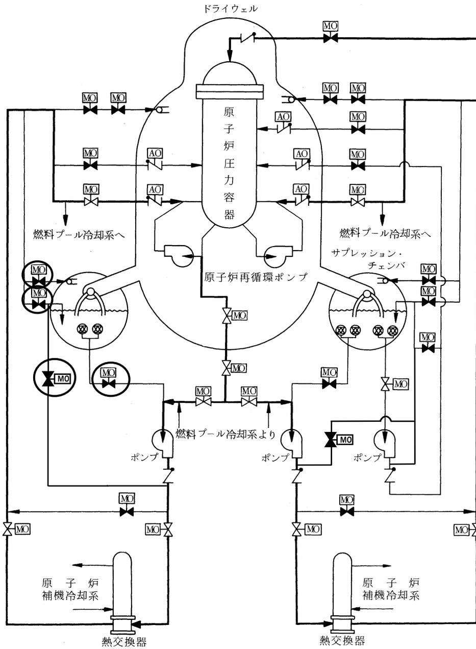
図2 残留熱除去系（原子炉停止時冷却モード）系統概要図
