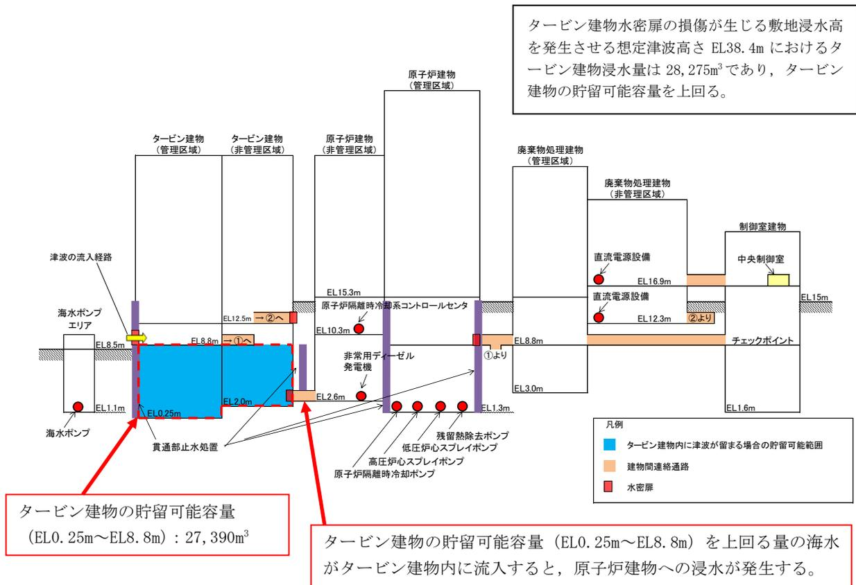
図7 建物内浸水経路概要図
