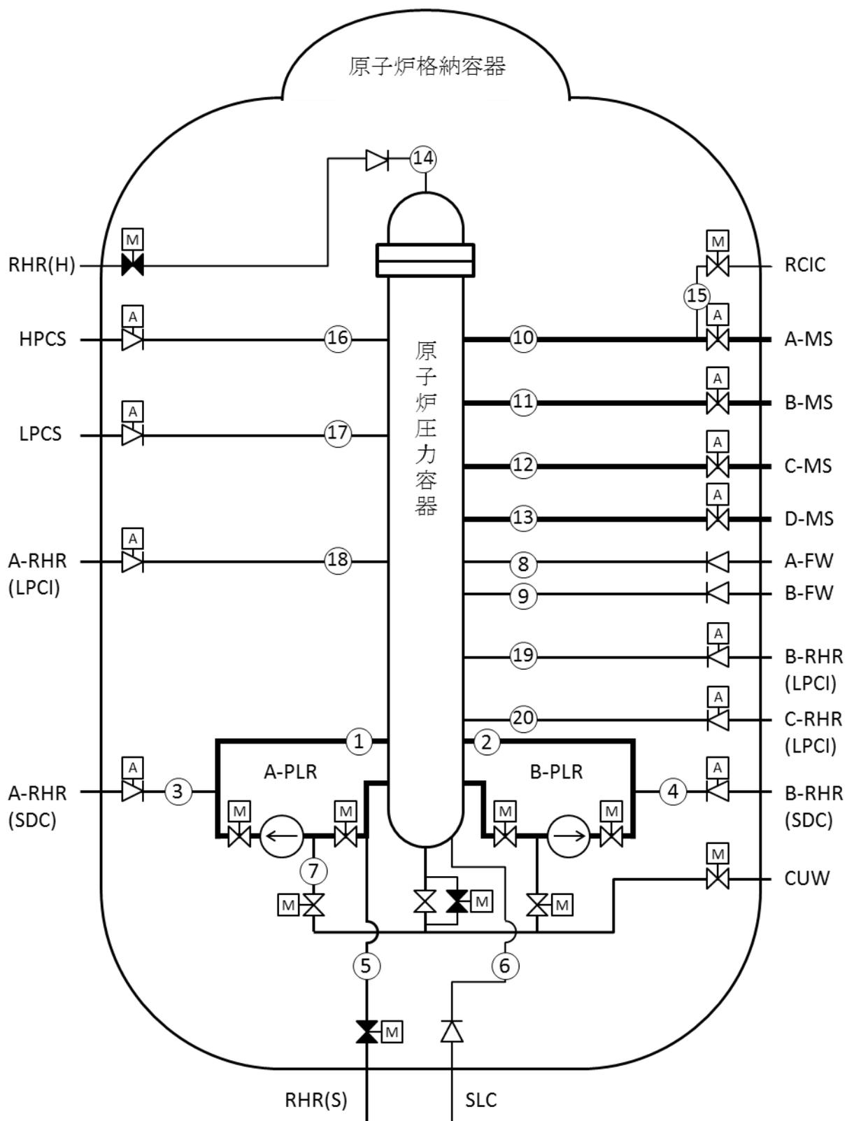
図2 格納容器内配管と破断想定箇所の概要
