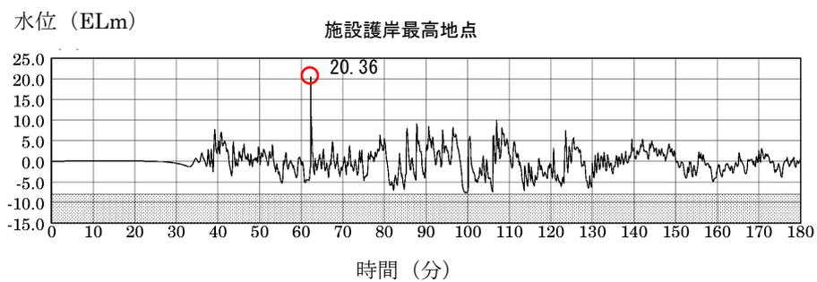
図2 施設護岸最高水位地点での時刻歴波形
