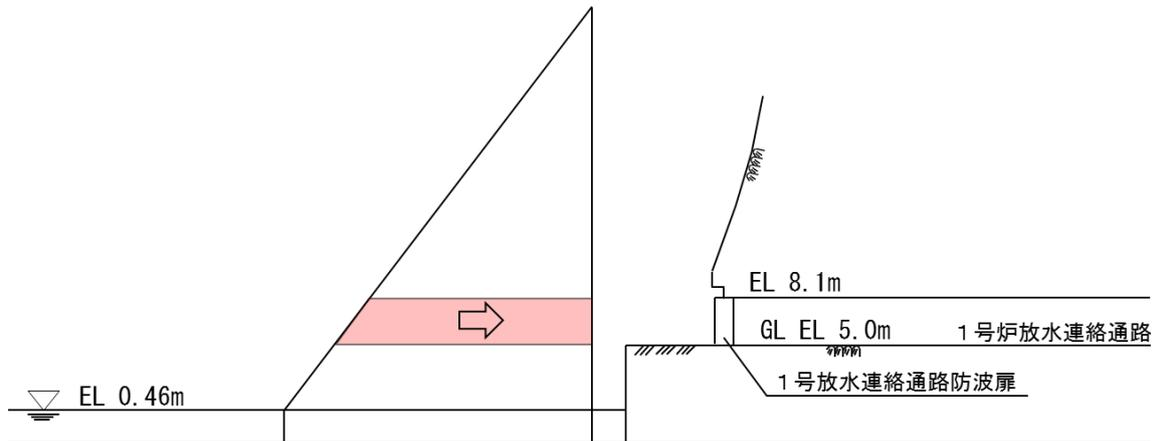
図 9 津波波力分布図（1号放水連絡通路防波扉）
