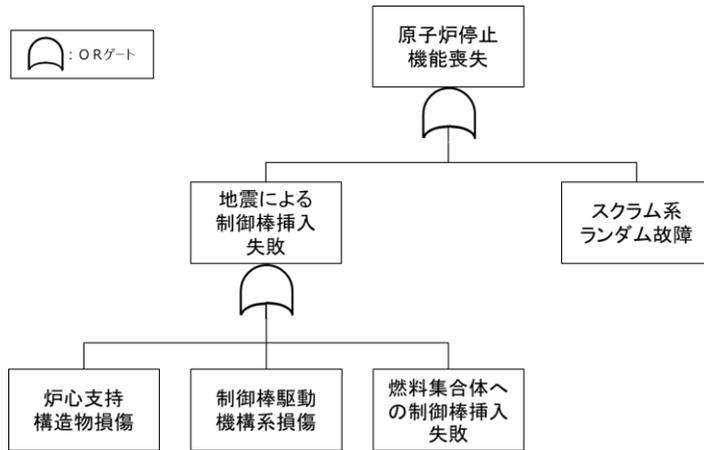
図1 原子炉停止機能喪失事象のフォールトツリー
