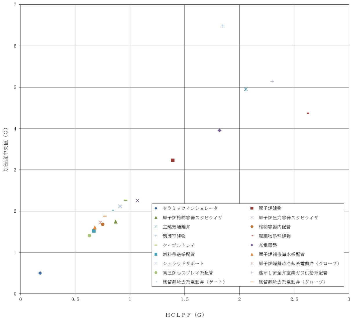
図1 起因事象／影響緩和機能の主な建物・構築物・機器フラジリティ
