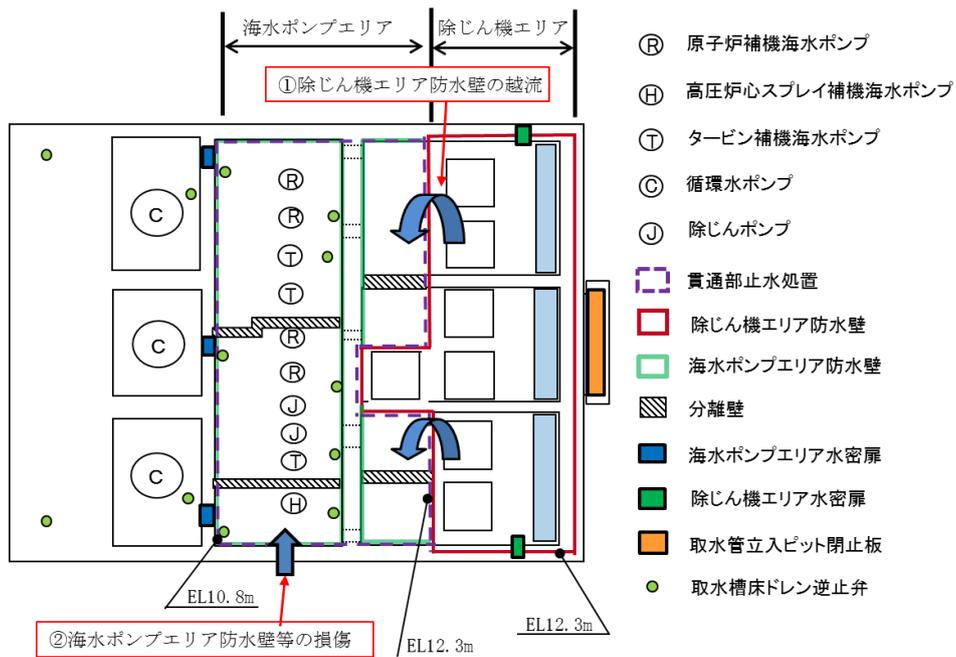
図6 原子炉補機海水ポンプの機能喪失要因
