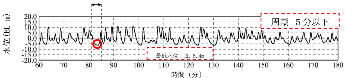
図 2 EL20m 津波での取水槽での時刻歴波形
