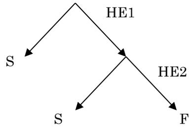
図4 原子炉冷却材浄化系ブロー時のLOCAのHRAイベントツリー
