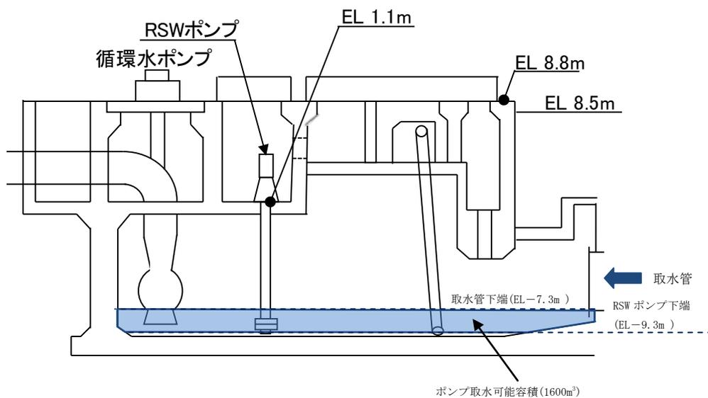
図4 取水槽の貯留構造部 (その2)
