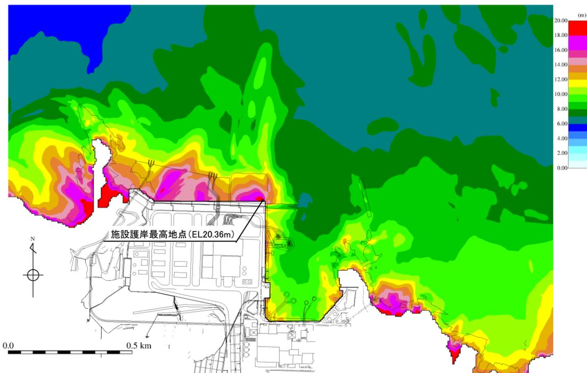
図1 施設護岸最高水位地点
