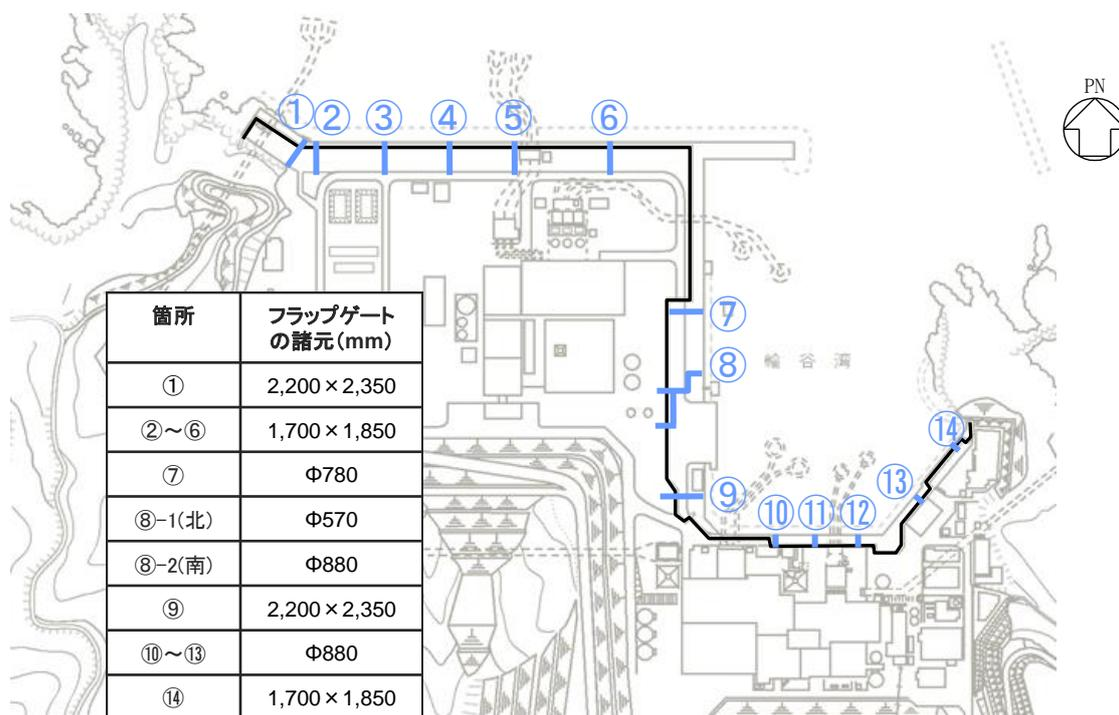
図 4 逆止弁配置図
