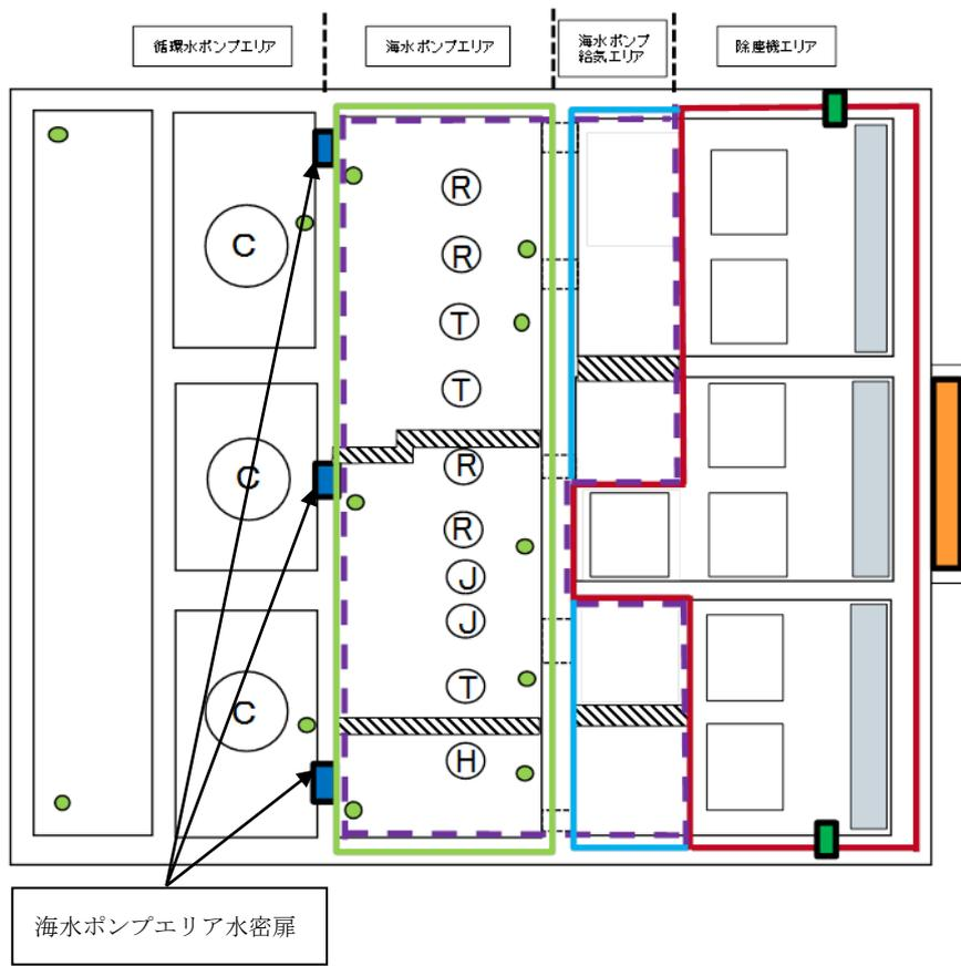
図3 海水ポンプエリア水密扉配置図
