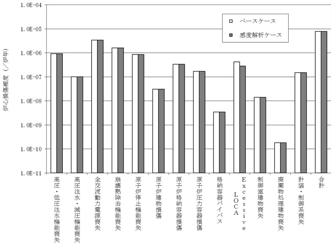
図5 炉心損傷頻度の比較（事故シーケンスグループ別）
