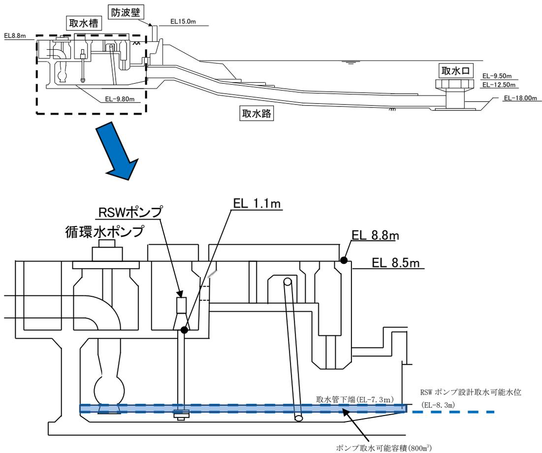
図3 取水槽の貯留構造部 (その1)
