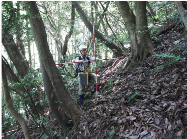
P4 地滑り土塊とされる斜面の中腹部の状況 斜面傾斜45度の等斉斜面。県道付近よりP2の末端部まで、顕著な傾斜変化は認められない。
