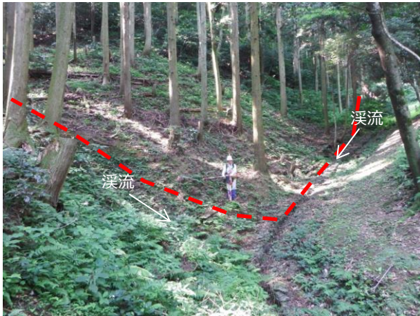
P5 地滑り土塊とされる斜面の末端部の状況 防災科研調査の地滑り土塊の末端部は2条の溪流の合流点にあたる。急斜面をなすが、等斉斜面である。樹木(幹径最大50cm)に地滑りを示唆する根曲りは認められない。
