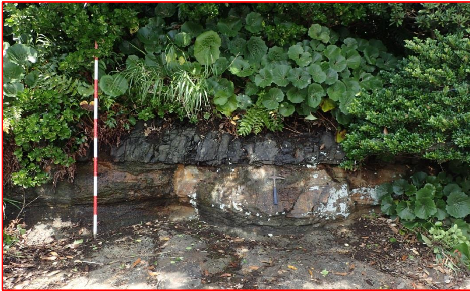
P2 斜面端部 斜面端部は黒色頁岩・凝灰岩の互層，C H 級である。
