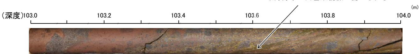
破碎部中に白色鉱物(オパールCT)の鉱物脈が認められる事例 (試料viii. H-1.1孔 深度103.62m付近)
