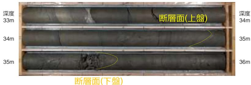
●H-m2断層 (PT-3'孔(孔口標高:-28.68m))
