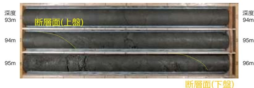
●H-m0断層 (PT-6孔(孔口標高:-28.89m))
