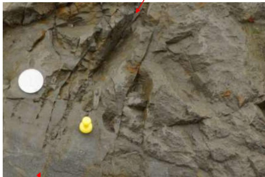
※ゆ着型断層は、断層面露出後の風化等の影響により、断層面が軟質化し、開離型断層と同様な性状を呈する場合があるため、断層面露出直後の性状により判断している。
