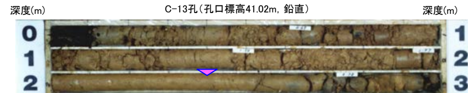
コア写真(C-13孔 深度0~3m) 岩盤(深度2.40m~)の上位に堆積物(シルト)が認められる
