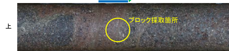
ボーリングコア写真(N-2.3-1孔)
