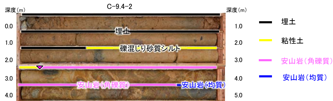
コア写真(深度0~5m) ▼ 礫混じり砂質シルトと安山岩(角礫質)の境界 (EL19.42m)
