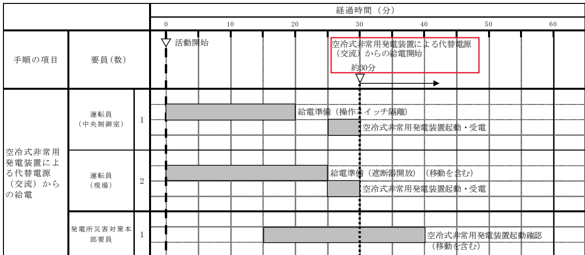
第 1.14.8 図 空冷式非常用発電装置による代替電源（交流）からの給電タイムチャート
