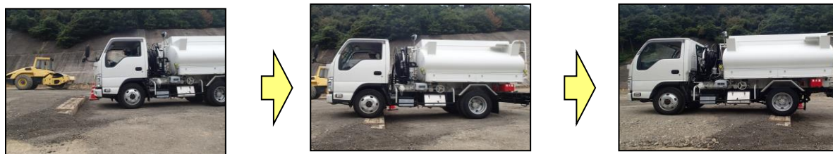
第2図 段差復旧前の走行性能検証(2/2)
