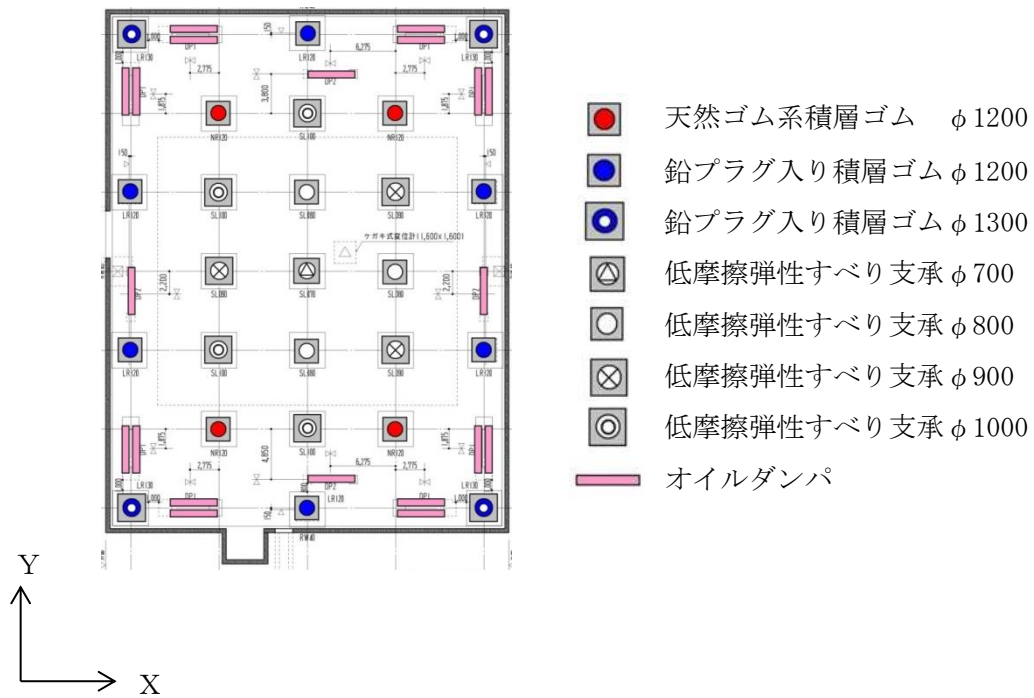
第3図 免震装置配置図
