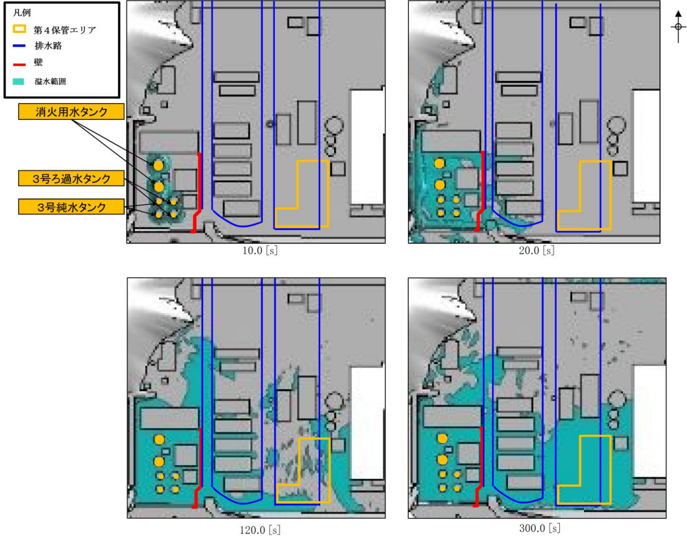
図1 第4保管エリア近傍の溢水の伝播挙動
