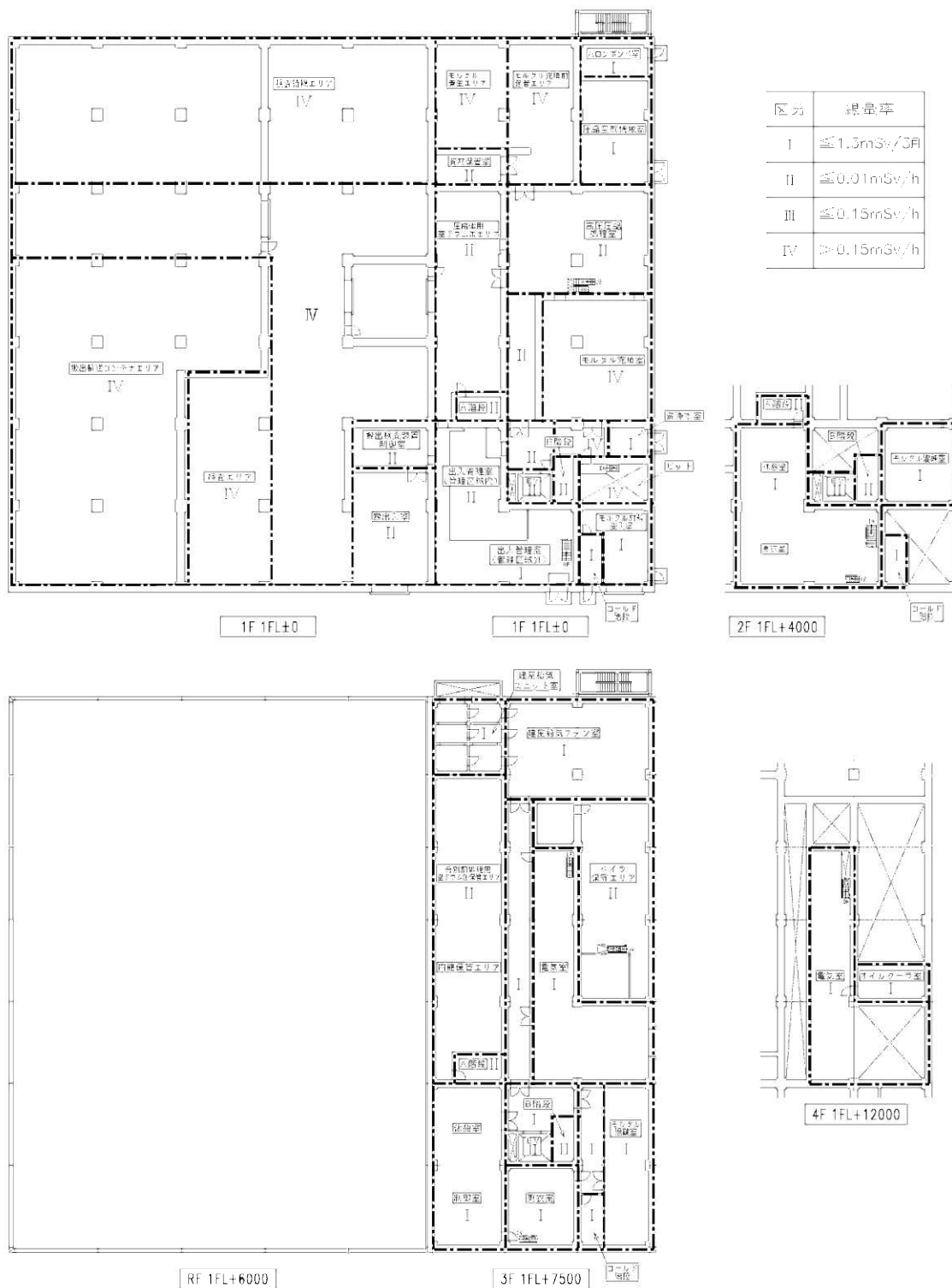
第 30-3 図 廃棄物搬出建屋の線量率区分(1/2)
