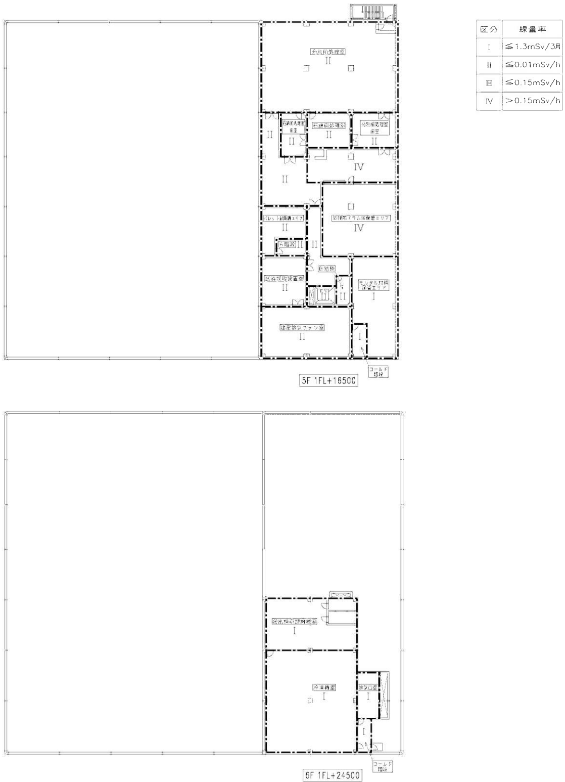
第 30-3 図 廃棄物搬出建屋の線量率区分 (2/2)
