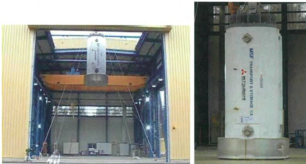
図 3 9.3m 頭部垂直落下試験時の試験体写真
