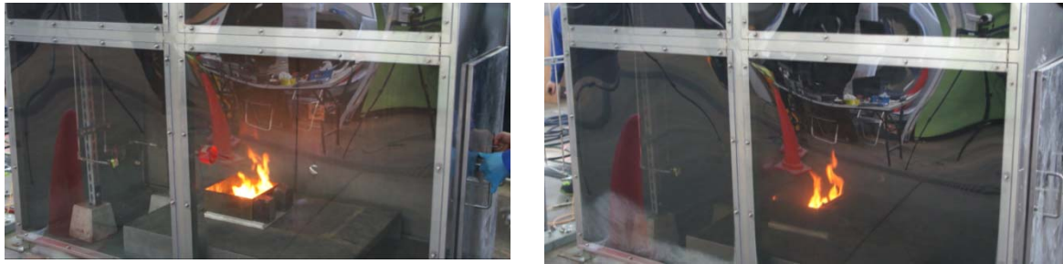
図1. グローブボックス擬態体内における潤滑油の燃焼状況
