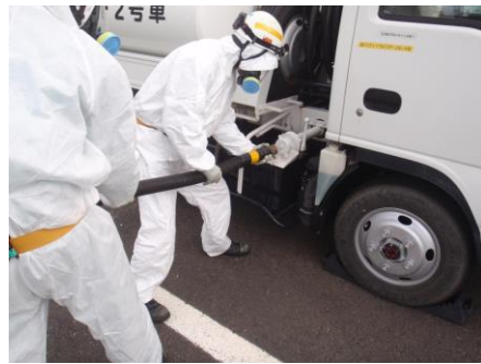
タンクローリへの燃料ホース接続
