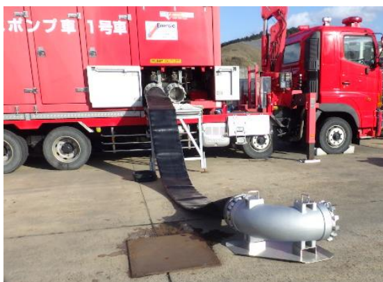
大型送水ポンプ車 (8.5m盤 (荷揚げ場にて模擬操作))
