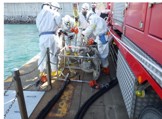
大型送水ポンプ車 (8.5m盤 (荷揚げ場にて模擬操作))
