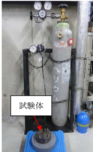
図5 He 気密確認試験状況
