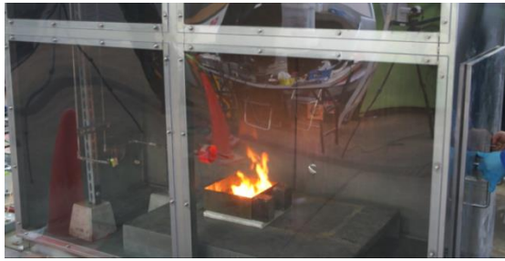
図1. グローブボックス模擬態体内における潤滑油の燃焼状況
