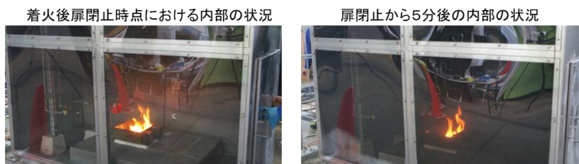
図 2 - 1 . 消火試験におけるカメラの視認性能確認
