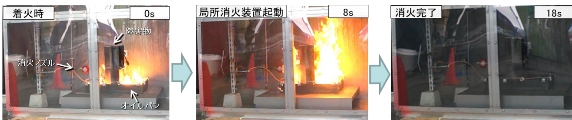
図 1-2. グローブボックス内消火試験の状況
