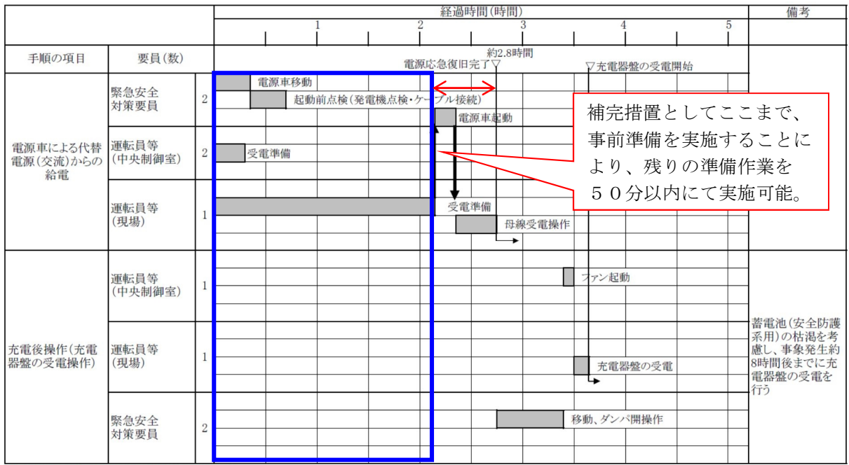
第1.14.15図 電源車による代替電源(交流)からの給電 タイムチャート
