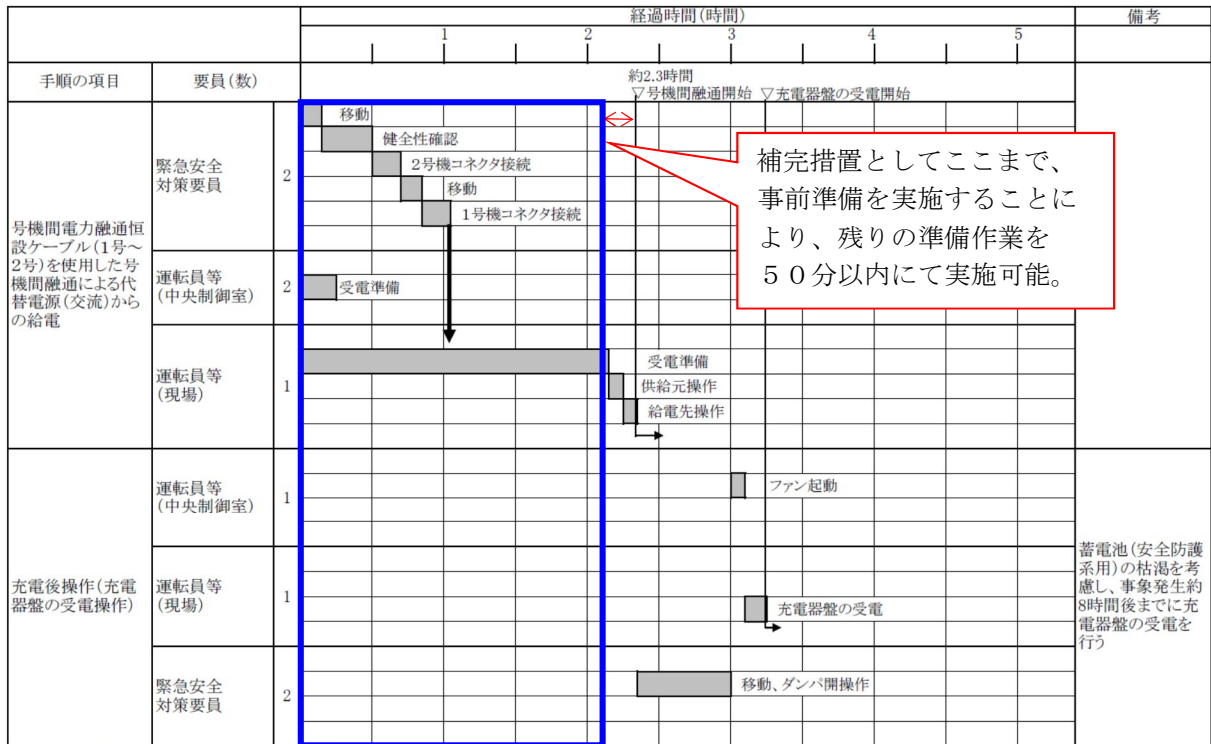
第1.14.8図 号機間電力融通恒設ケーブル（1号～2号）を使用した号機間融通による代替電源（交流）からの給電タイムチャート
